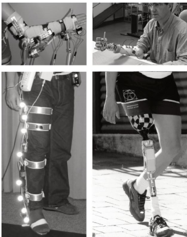
Figura 2 - Robótica de reabilitação exoesqueletos versus próteses robóticas (PONS, CERES e CALDERÓN, 2009)
