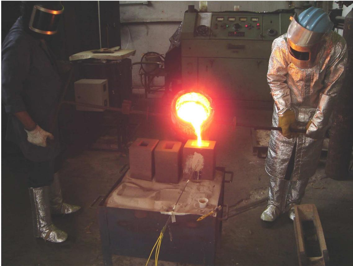
Figura 3.6 - Vazamento no molde de areia.
