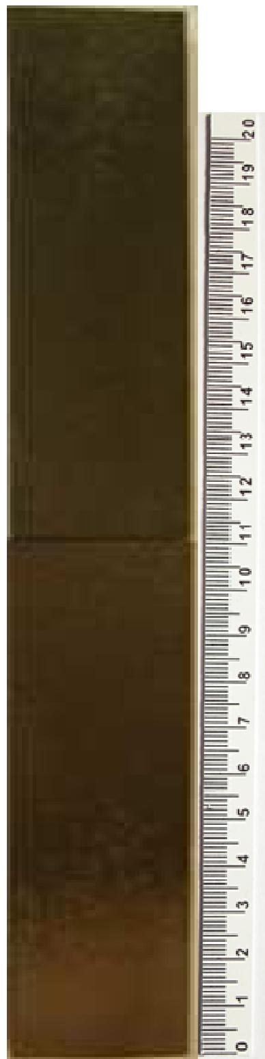
Figura 4.11 - Macrografias das secções longitudinais dos lingotes obtidos no dispositivo de solidificação unidirecional para o ferro fundido cinzento (a) com inoculante e (b) sem inoculante.
