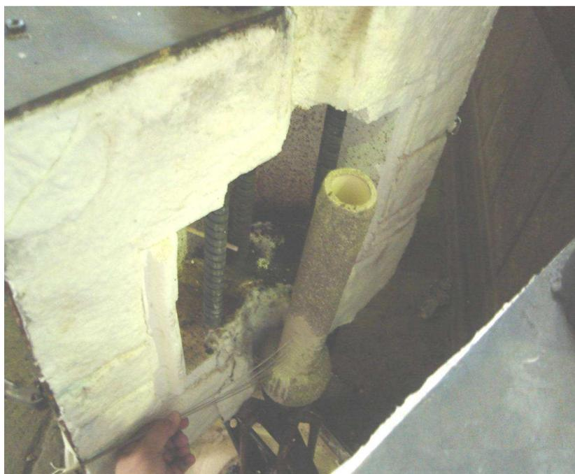
Figura 3.5 - Dispositivo de solidificação unidirecional montado.
