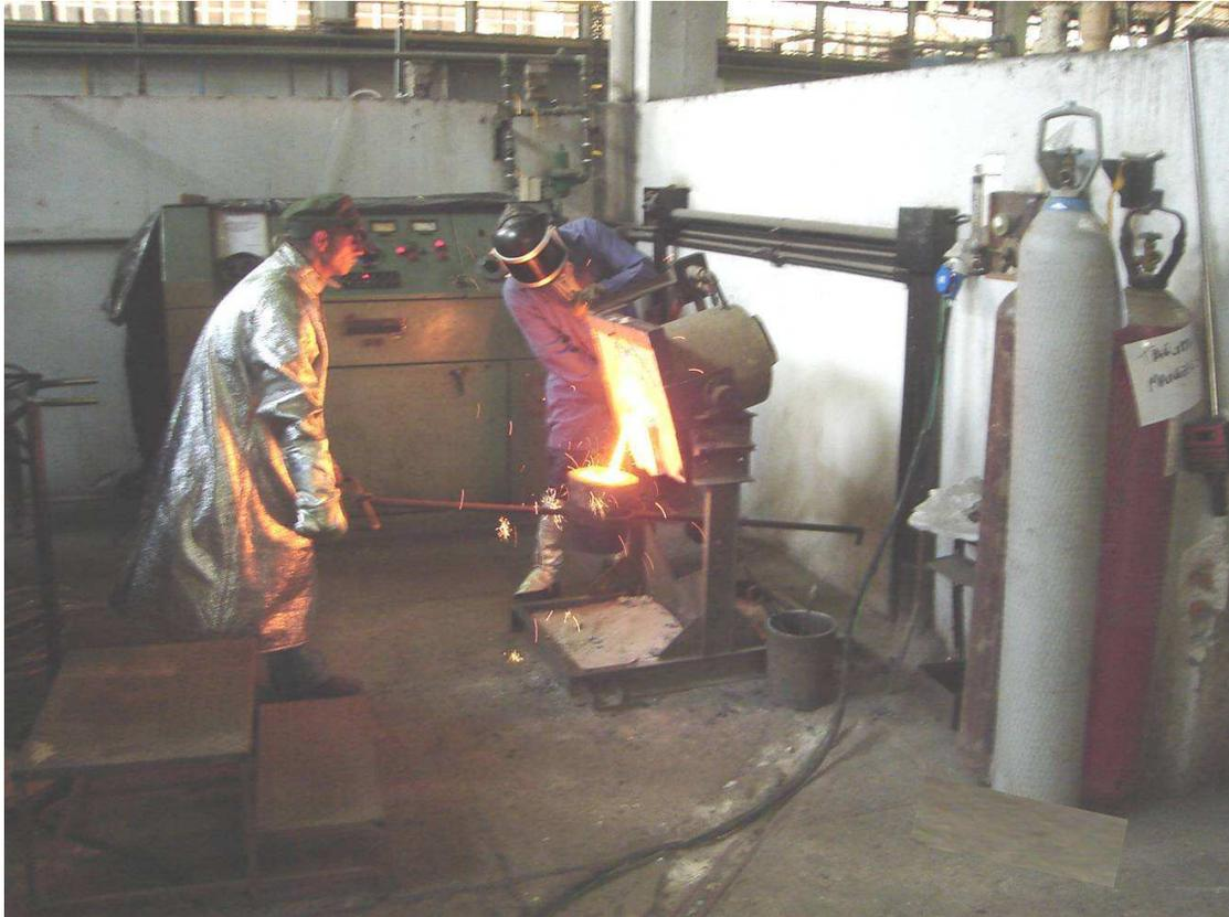
Figura 3.3 - Forno de indução utilizado para a elaboração das corridas.
