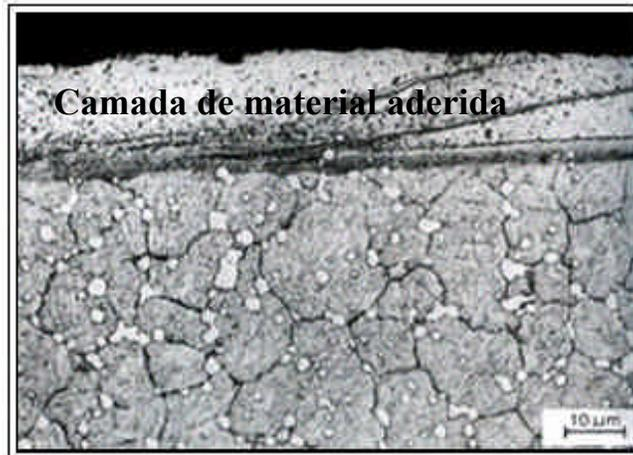
**Figura 3.7: Secção da superfície de saída de uma ferramenta de aço rápido após usinar um aço inoxidável austenítico (TRENT, 2000).**
