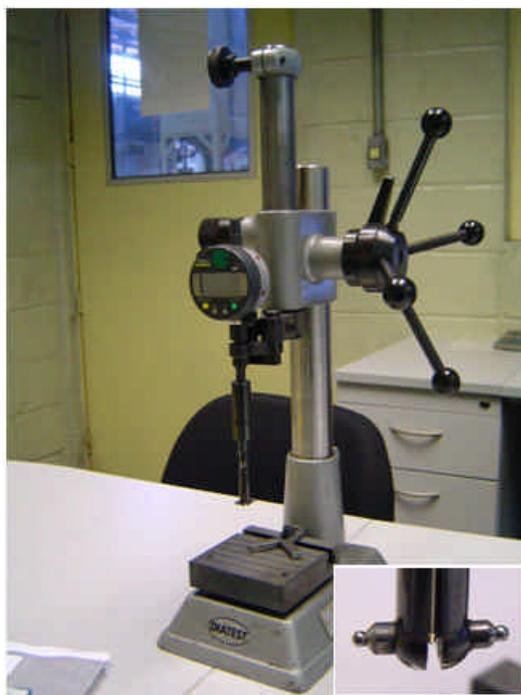
**Figura 5.9: Dispositivo de medição do perfil interno.**
