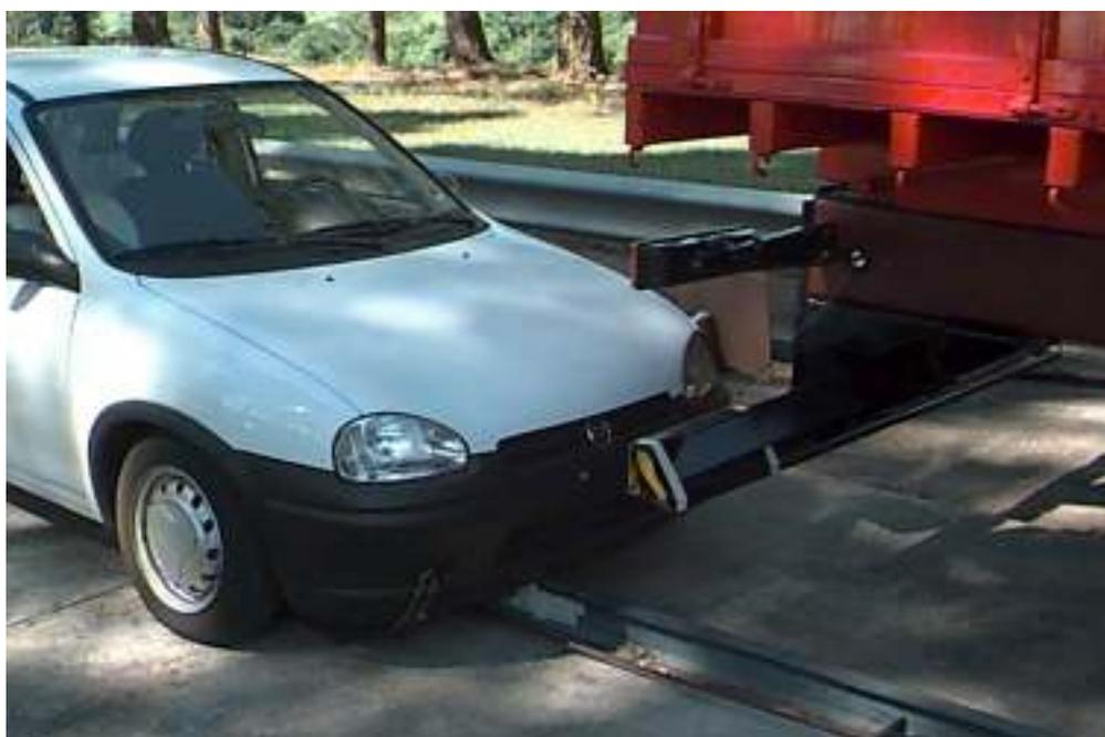
Figura 8.6: Posição do automóvel em relação ao pára-choque articulado antes do *crash test*.
