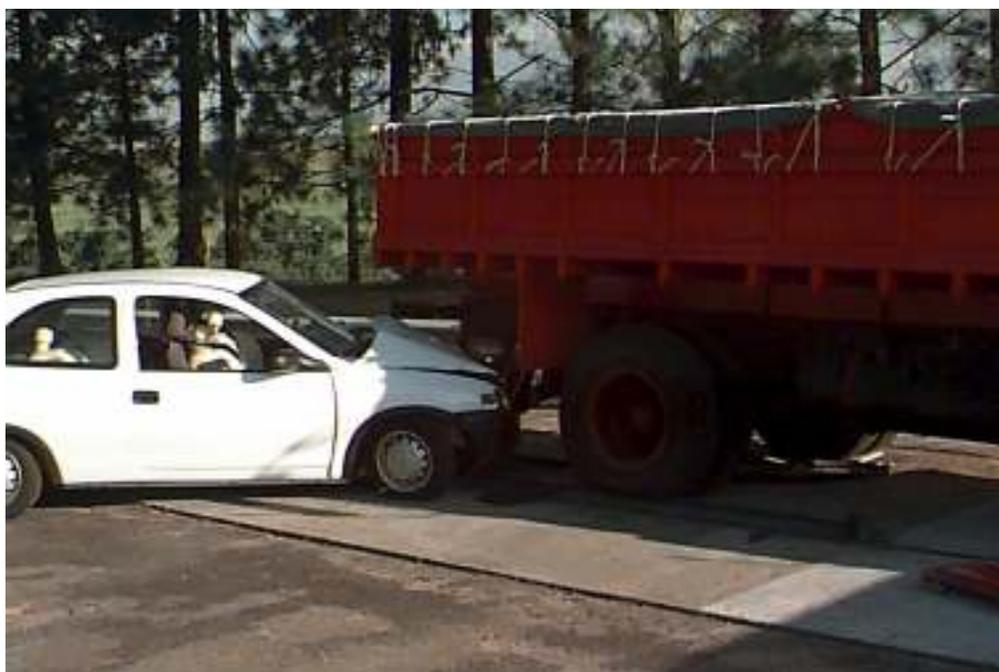
Figura 8.15: Posição final do automóvel após o impacto contra o pára-choque articulado (vista lateral).
