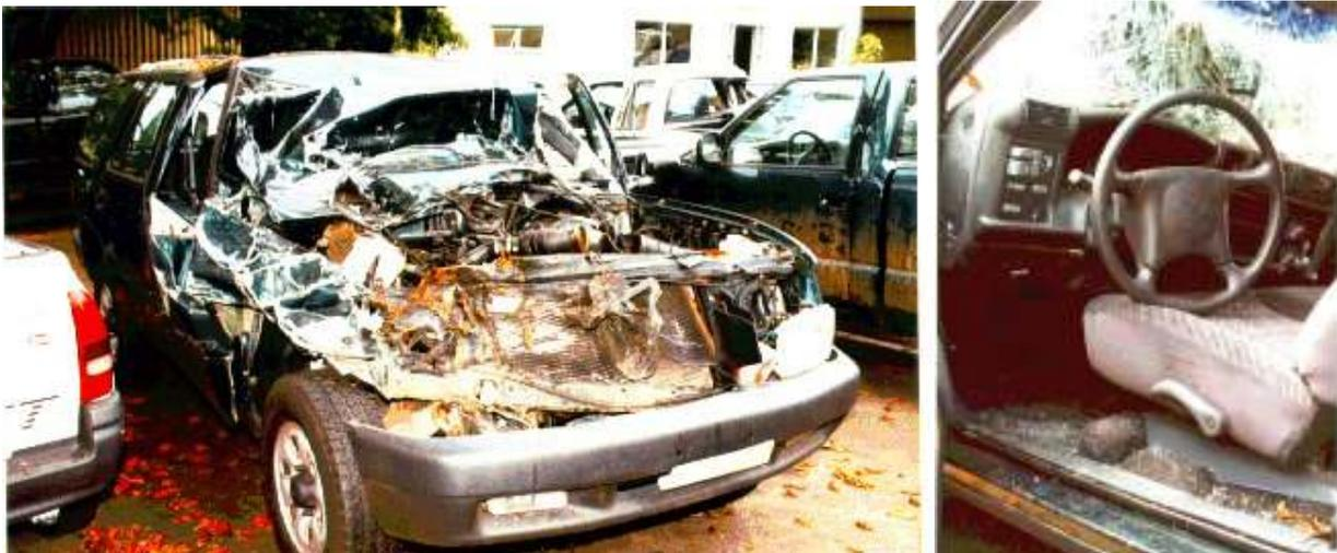
Figura 4.7: Acidente real envolvendo a traseira de um caminhão e uma Chevrolet Blazer. No detalhe, o volante da Blazer encostado no assento do motorista.
