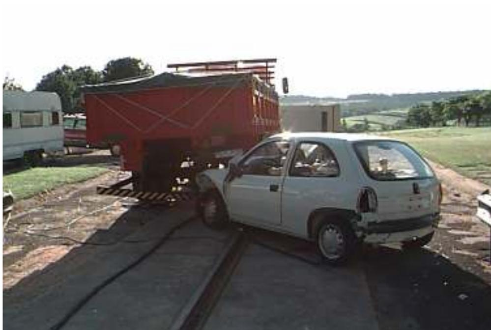
Figura 8.16: Posição final do automóvel após o impacto contra o pára-choque articulado (vista traseira).
