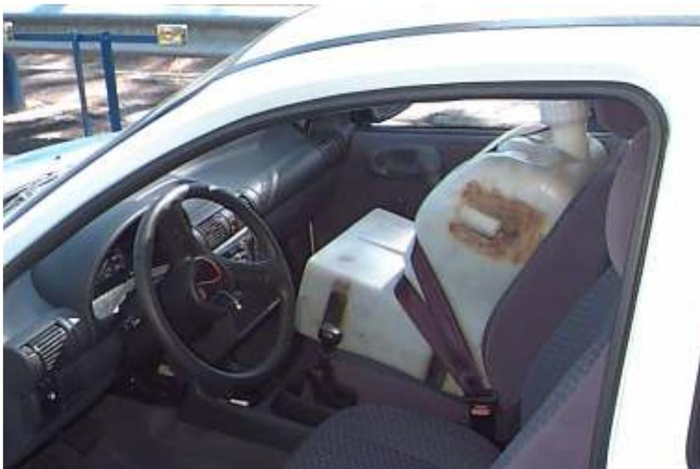
Figura 8.7: Lastro de água utilizado como simulação de passageiros.
