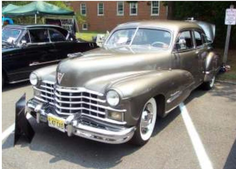
Figura 1.4: Cadillac 1947. A altura e o comprimento da região frontal deste e de outros automóveis da época dificultavam a ocorrência do efeito guilhotina.
