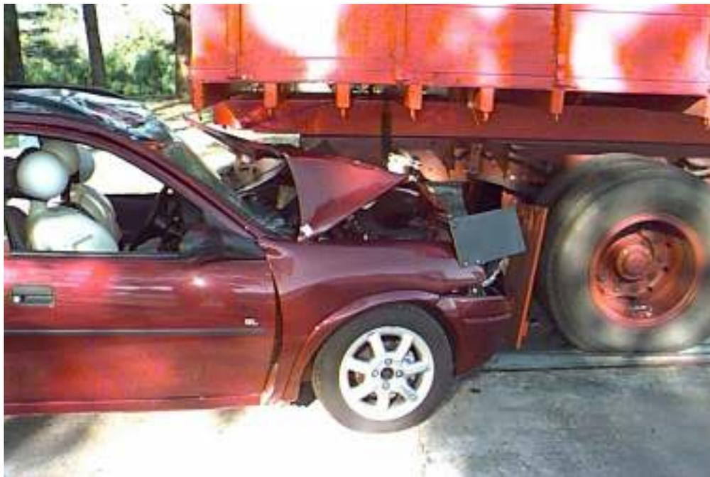
Figura 8.24: Posição final do automóvel após o impacto contra o pára-choque de acordo com a Resolução CONTRAN No. 805/95 (vista lateral).
