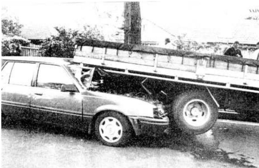
Figura 4.5: Demonstração do efeito de cunha em um acidente real (Rechnitzer e Foong, 1991).
