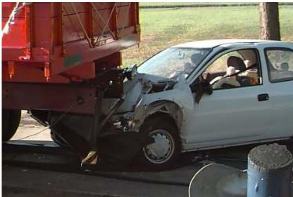
Figura 8.14: Posição final do automóvel após o impacto contra o pára-choque articulado (vista lateral).
