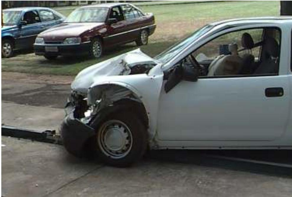
Figura 8.20: Aspecto do automóvel após o teste.
