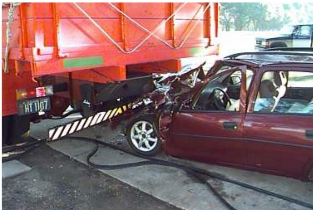
Figura 8.25: Outra vista lateral do impacto contra o pára-choque construído de acordo com a Resolução CONTRAN No. 805/95.
