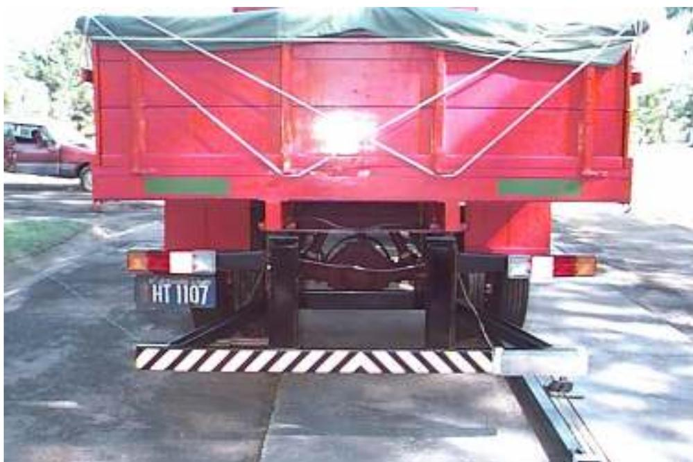
Figura 8.4: Vista traseira do caminhão equipado com o pára-choque articulado antes do *crash test*.
