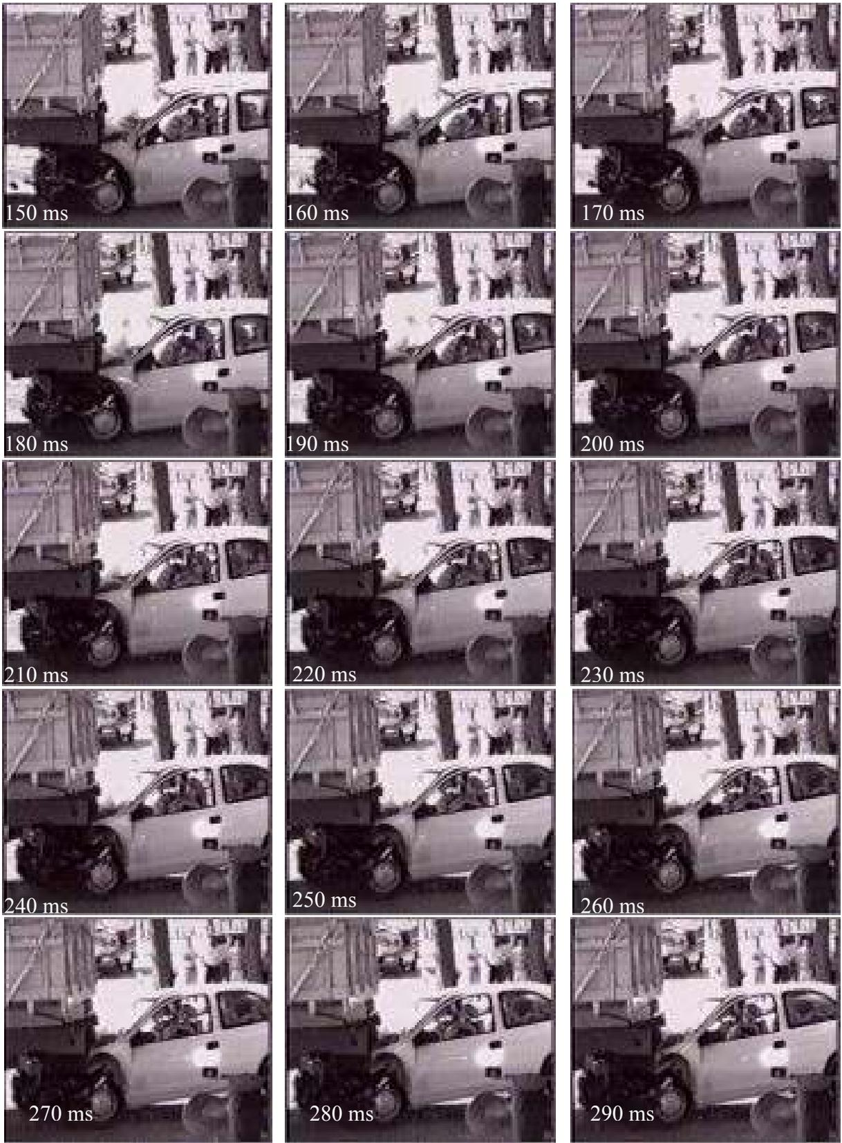
Figura 8.12: Seqüência de fotos do *crash test* do pára-choque articulado.
