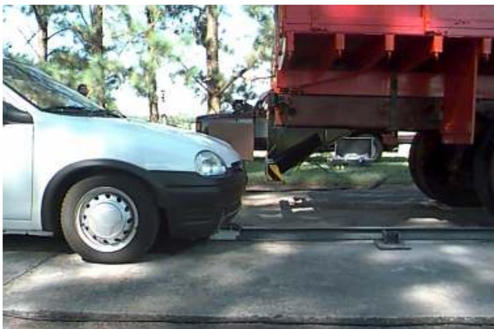
Figura 8.5: Altura do pára-choque articulado em relação ao pára-choque do automóvel.
