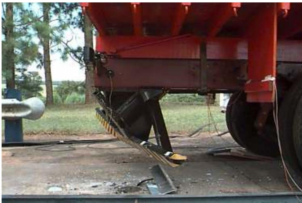
Figura 8.18: Aspecto do pára-choque ao final do teste (vista lateral).
