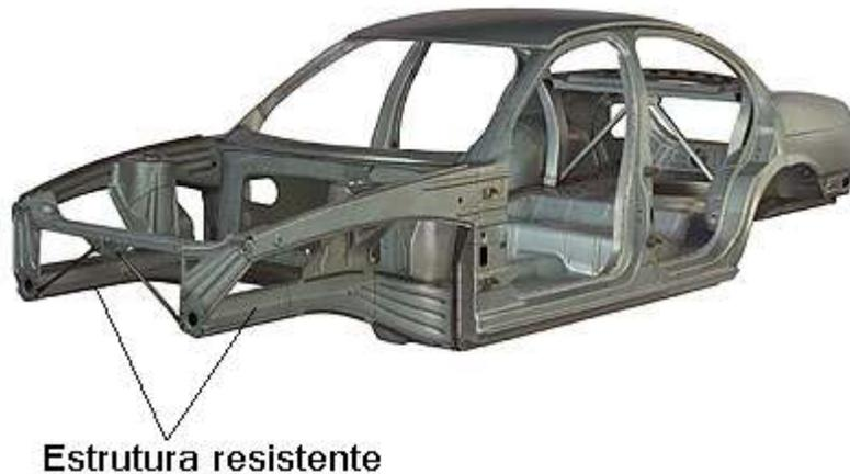
Figura 4.1: Posição da estrutura dimensionada para absorver a energia de impactos frontais.
