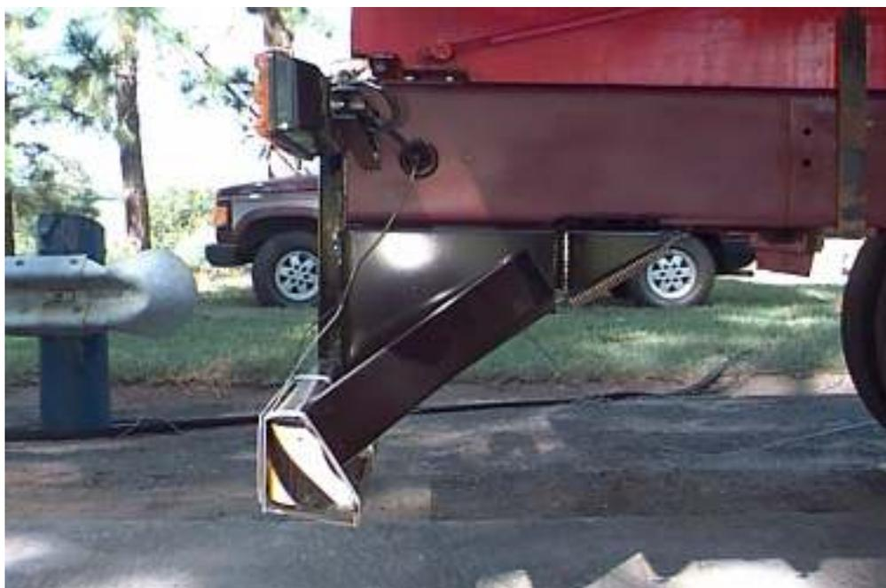
Figura 8.3: Vista lateral do pára-choque articulado antes do *crash test*.
