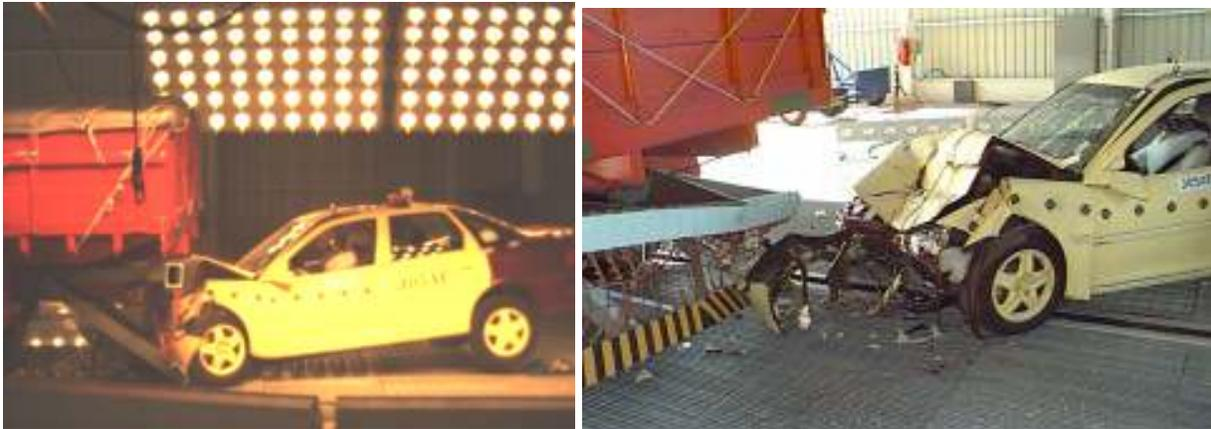
Figura 3.7: Impacto do veículo contra o pára-choque alicate (esquerda) e posição final do mesmo.
