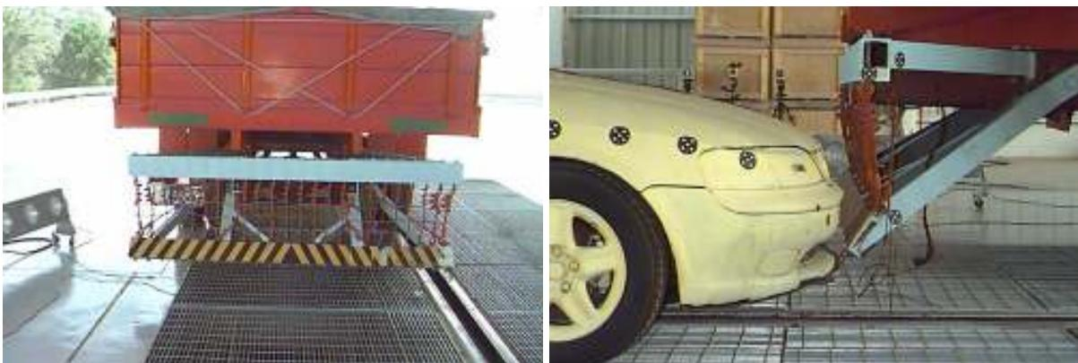
Figura 3.6: Pára-choque alicate antes do *crash test*.
