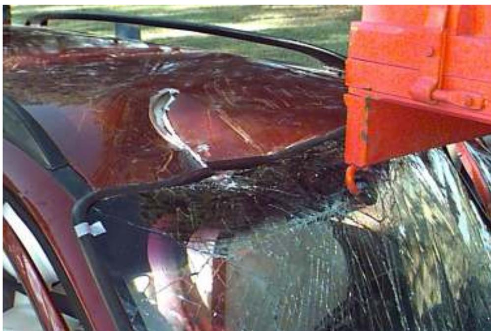
Figura 8.30: Rasgo produzido no teto do automóvel pelo gancho da carroceria do caminhão.
