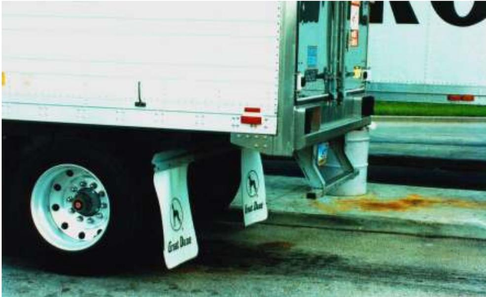
Figura 2.3: Exemplo de um típico pára-choque construído de acordo com a regulamentação norte-americana 49 CFR 393.86, conhecido como pára-choque ICC.
