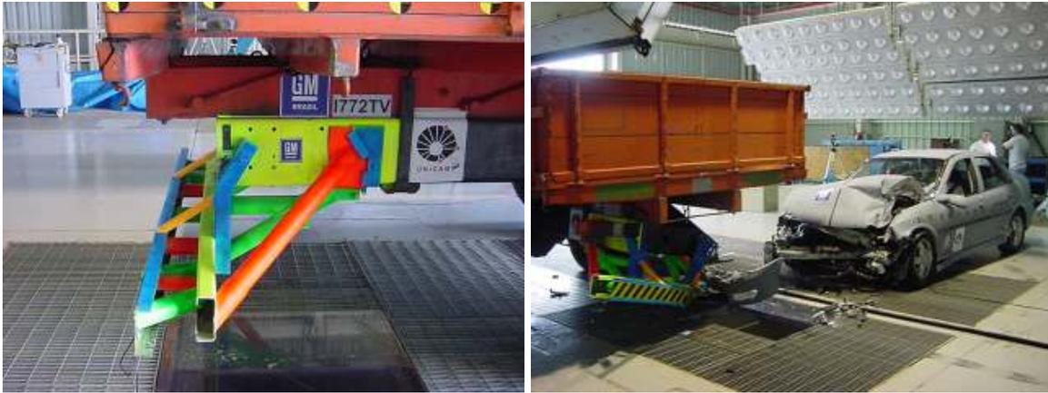
Figura 3.9: Pára-choque absorvedor de energia antes e depois do teste. Os módulos absorvedores de energia são os tubos vermelhos e verdes.
