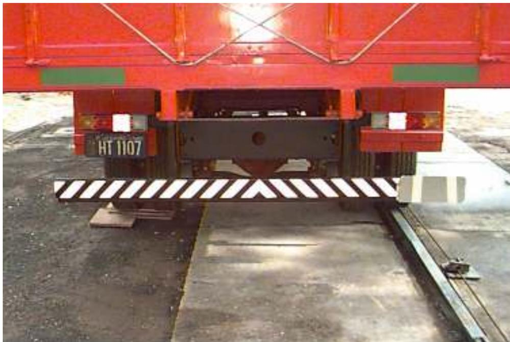
Figura 8.9: Vista traseira do caminhão equipado com o pára-choque construído de acordo com a Resolução CONTRAN No. 805/95.
