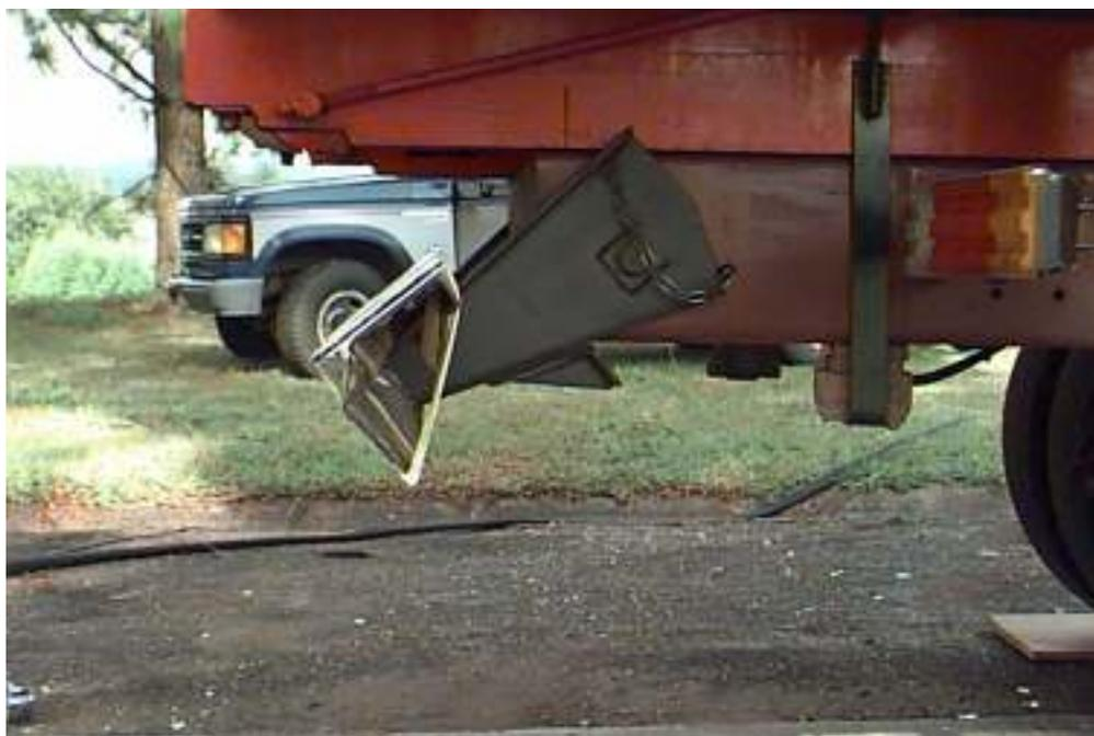
Figura 8.10: Vista lateral do pára-choque construído de acordo com a Resolução CONTRAN No. 805/95, que também apresentava capacidade de articulação.
