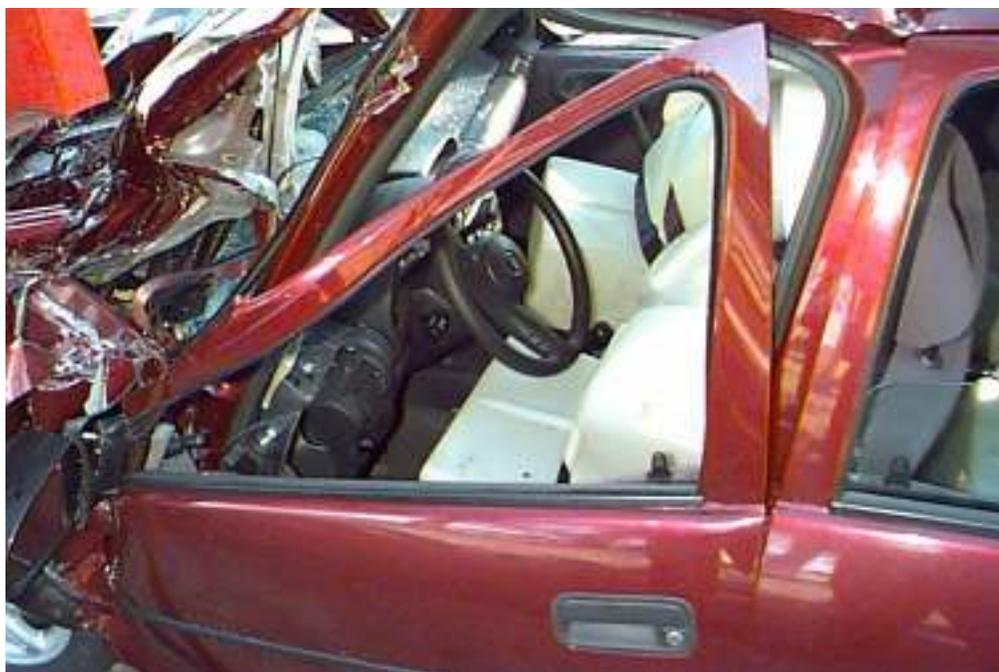
Figura 8.29: Detalhe do compartimento de passageiros do automóvel que colidiu contra o pára-choque construído de acordo com a Resolução CONTRAN No. 805/95.
