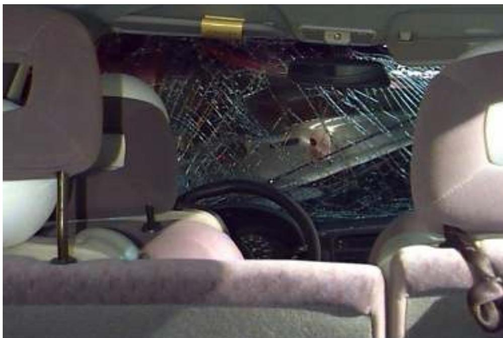
Figura 8.28: Pára-brisa rompido durante o *crash test*.
