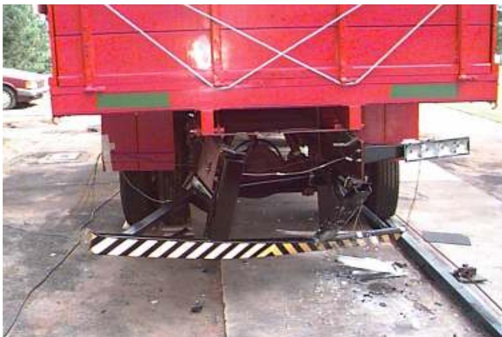
Figura 8.17: Aspecto do pára-choque ao final do teste (vista traseira).
