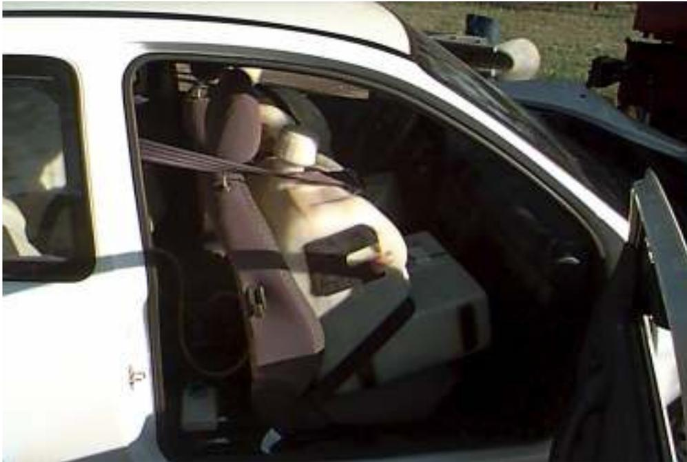
Figura 8.22: O compartimento de passageiros permaneceu intacto.
