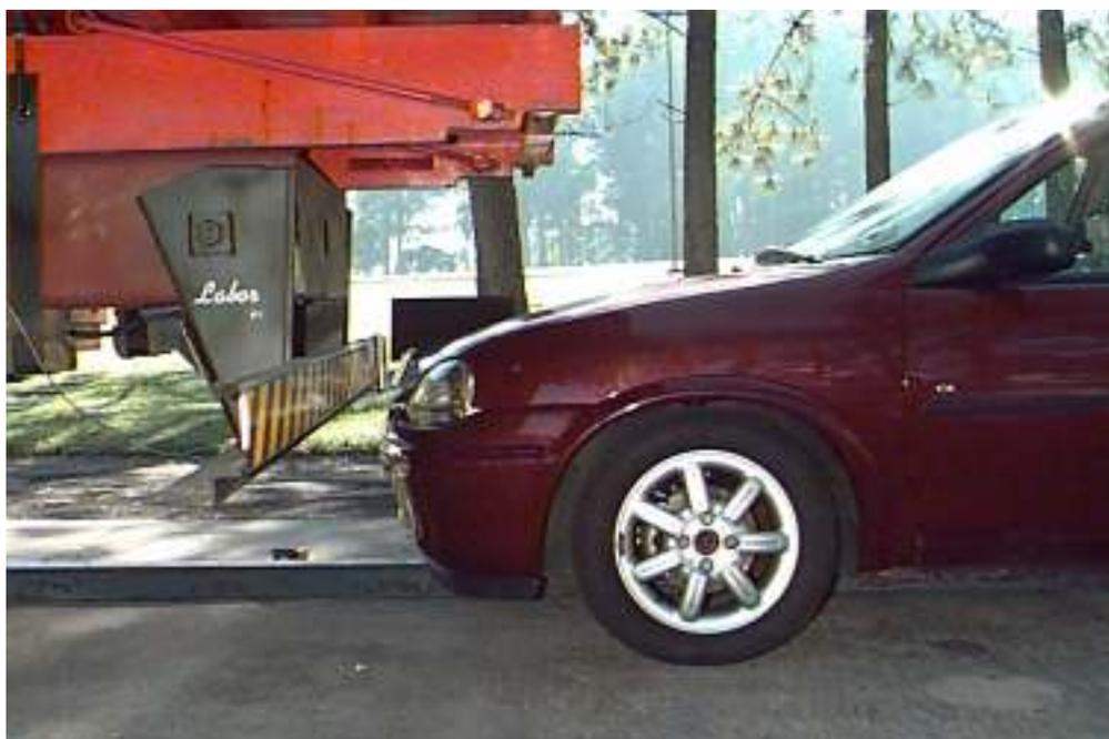
Figura 8.11: Posição do pára-choque construído de acordo com a Resolução CONTRAN No. 805/95 em relação ao pára-choque do automóvel.
