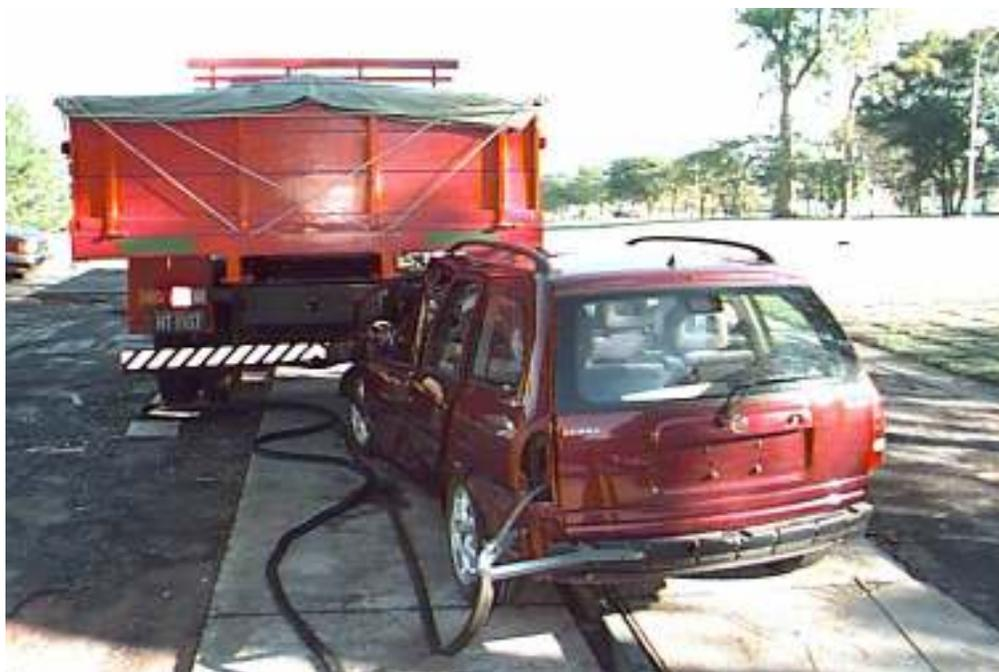
Figura 8.27: Posição final do automóvel após o impacto contra o pára-choque construído de acordo com a Resolução CONTRAN No. 805/95 (vista traseira).
