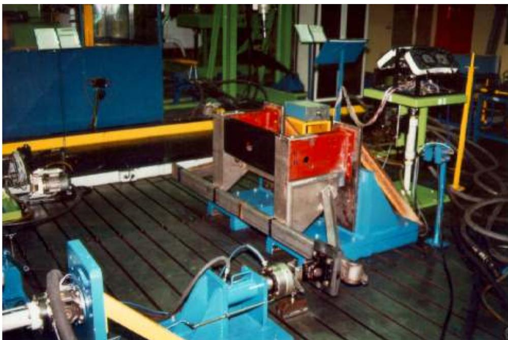
Figura 8.1: Teste estático do pára-choque articulado – aplicação da força P1.
