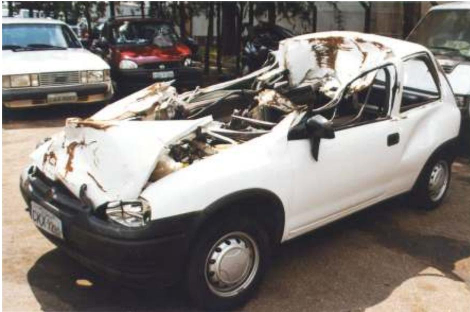
Figura 1.3: Exemplo da inutilidade dos modernos sistemas de segurança quando um automóvel colide contra a traseira de um caminhão.
