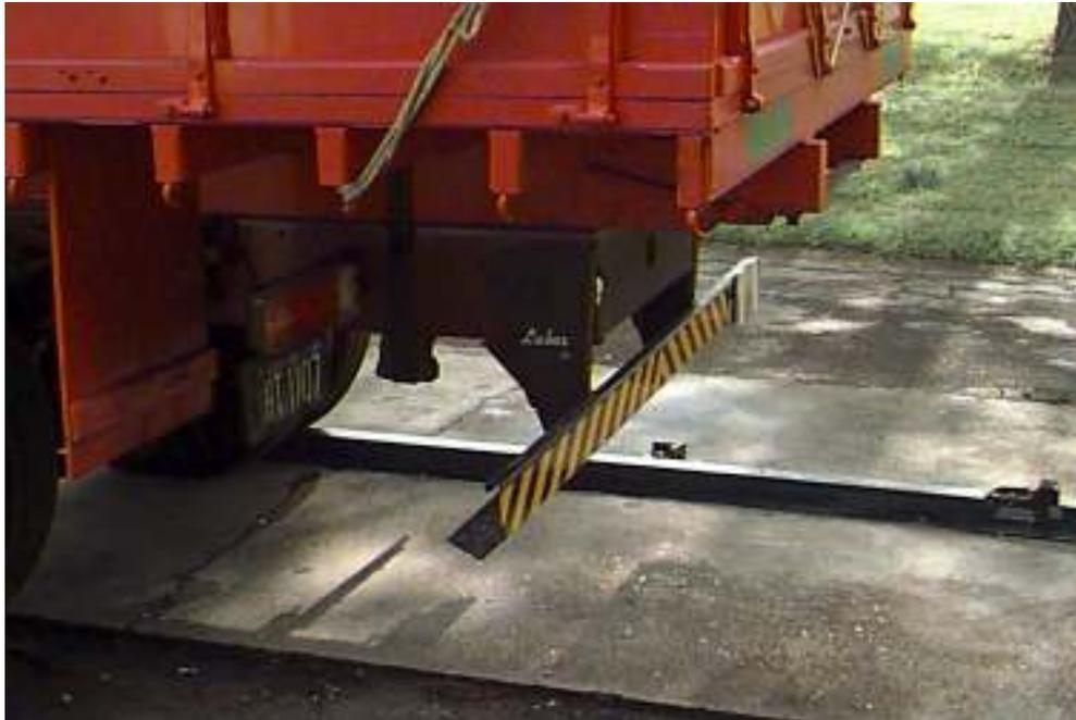
Figura 8.8: Vista do pára-choque construído de acordo com a Resolução CONTRAN No. 805/95.
