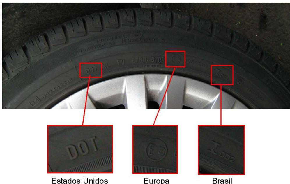
Figura 5: Inscrições referentes à homologação conforme diferentes normas.
