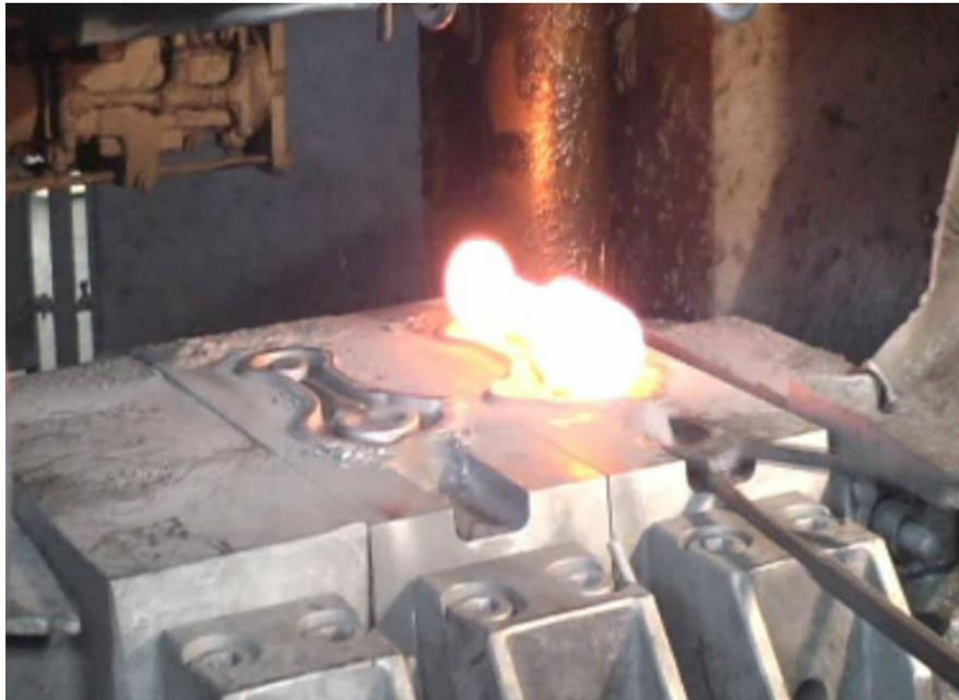
**Figura 3.4:** Processo de forjamento, pré-forma e matriz final [30].
