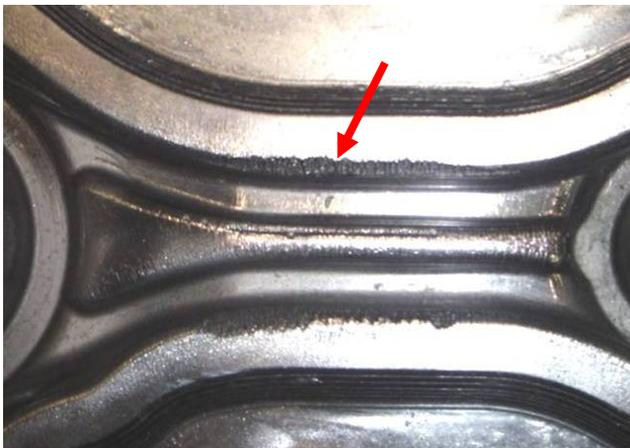
**Figura 2.3:** Desgaste abrasivo na região do raio [25].
