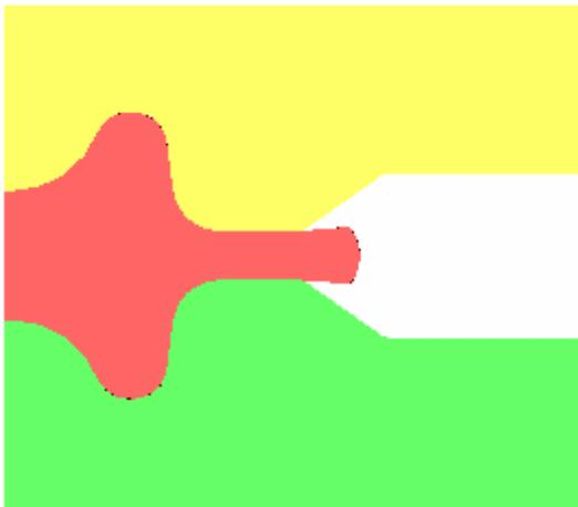
**Figura 7.2:** Rebarba em forma de “gota”, espessura de 4,2 mm.
