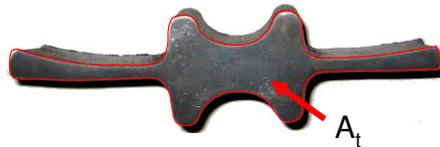
**Figura 3.14:** Secção da alma da biela com rebarba, vista frontal.
