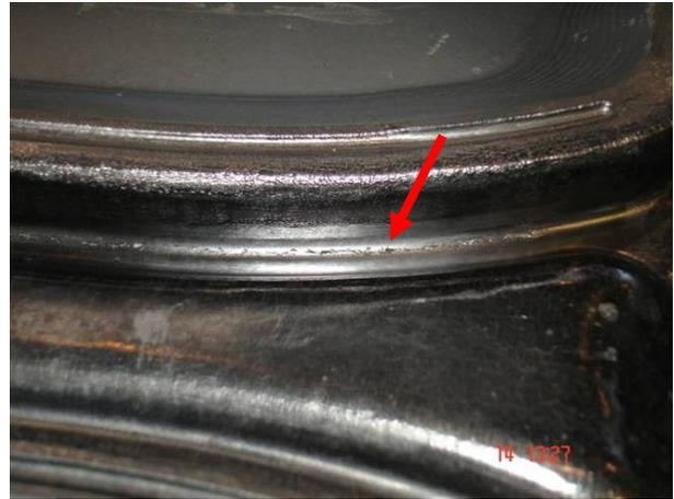
**Figura 2.6:** Fadiga mecânica, trinca [30].
