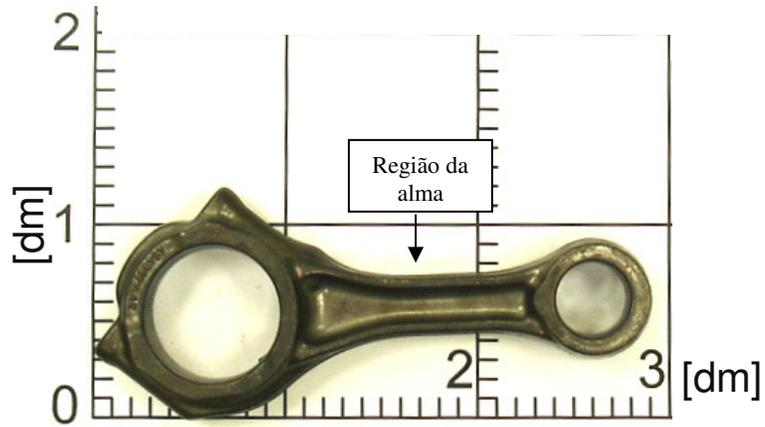
**Figura 3.5:** Dimensão final da biela forjada.
