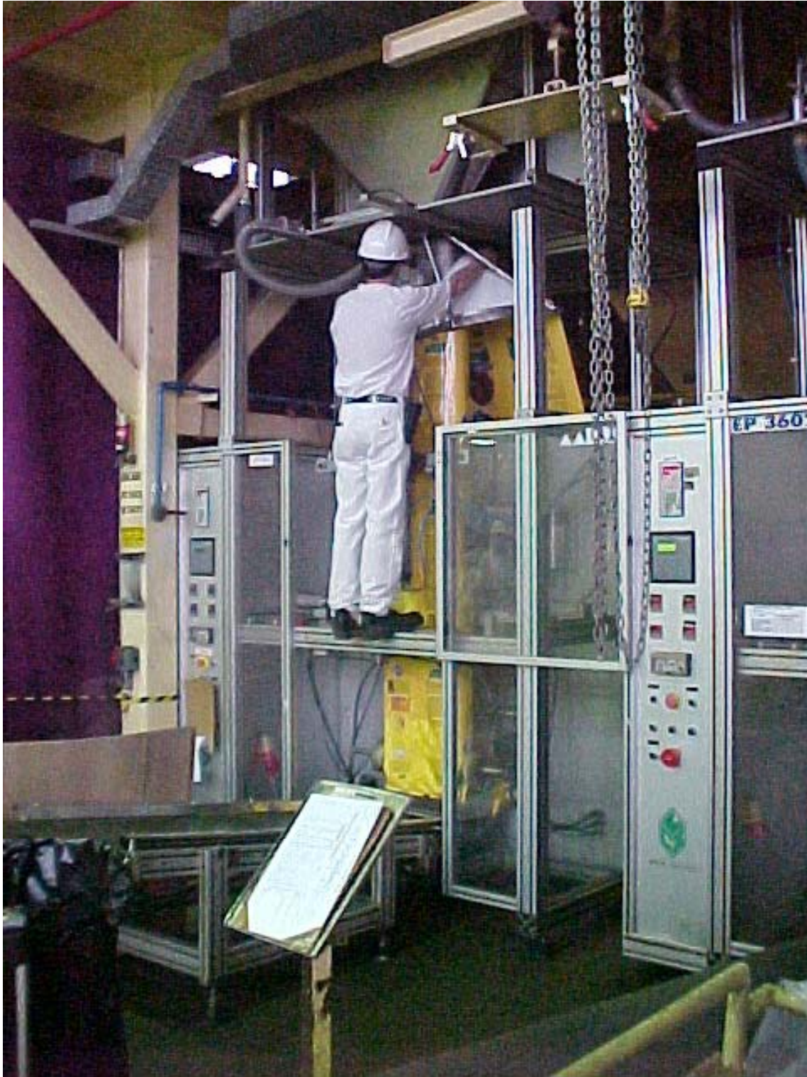
Figura 4.16: Simulação de uma troca antes da melhoria no empacotamento
