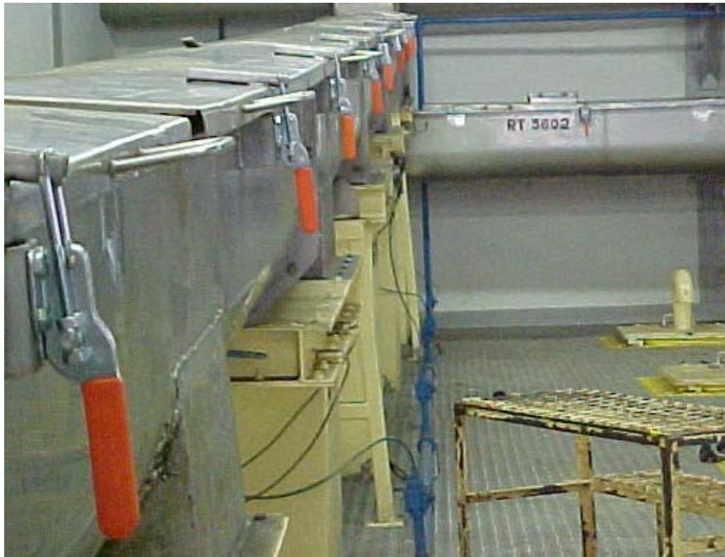
Figura 4.13: Foto das roscas transportadoras após melhoria - 2003
