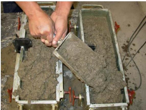
Figura 3.17 – Colocação do concreto na forma prismática
