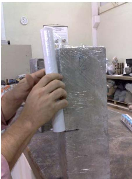
Figura 3.25 – Embalagem do corpo-de-prova com filme plástico
