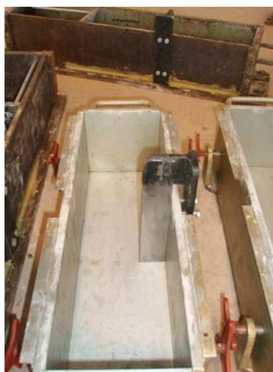
Figura 3.10 – Detalhe do dispositivo removível para caracterização do entalhe (vista lateral)
