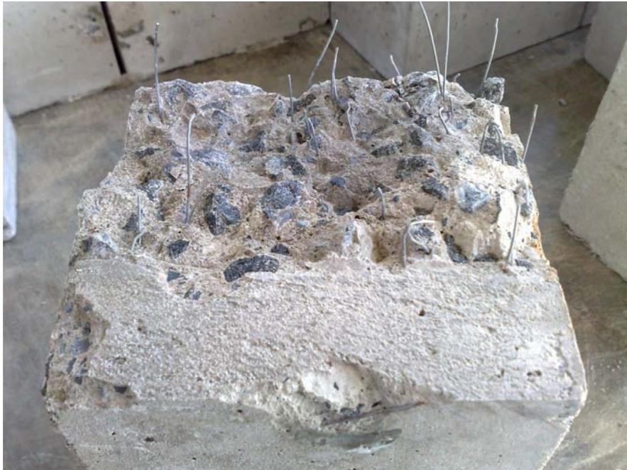
Figura 4.63 – Imagem da seção fraturada de corpo-de-prova de propagação de trinca por fadiga do CRF4 – 0,38%
