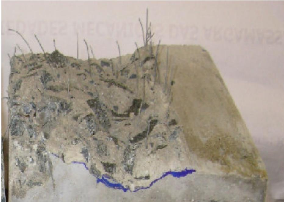
Figura 4.69 – Imagem da seção fraturada de corpo-de-prova de carga monotônica - CMOD do CRF5 0,38%
