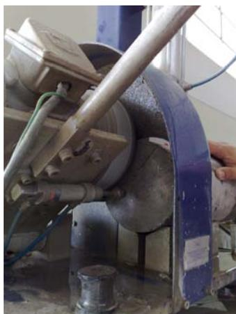
Figura 3.23 – Fresagem do corpo-de-prova cilíndrico
