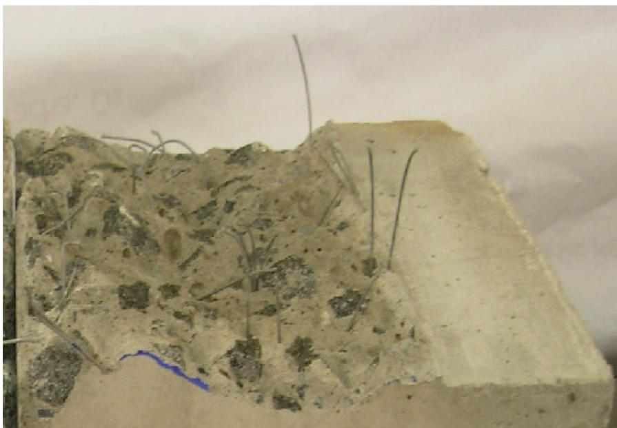
Figura 4.67 – Imagem da seção fraturada de corpo-de-prova de carga monotônica - CMOD do CRF3 0,38%
