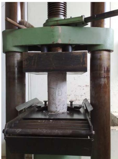
Figura 3.27 – Ensaio de compressão axial
