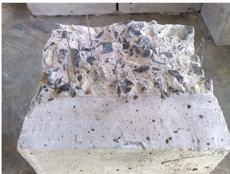
Figura 4.62 – Imagem da seção fraturada de corpo-de-prova de propagação de trinca por fadiga do CRF3 – 0,38%
