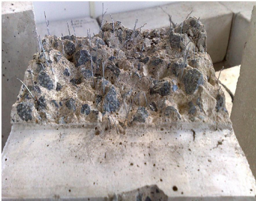
Figura 4.64 – Imagem da seção fraturada de corpo-de-prova de propagação de trinca por fadiga do CRF5 – 0,38%
