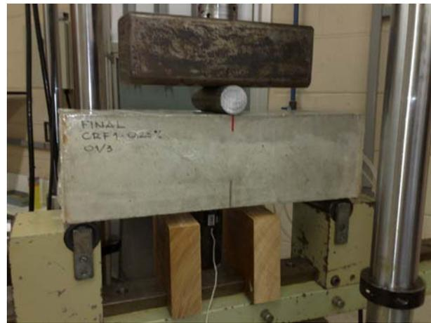
Figura 3.34 – Crescimento da trinca no corpo-de-prova
