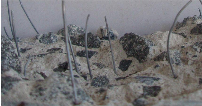
Figura 4.31 – Aspecto das fibras metálicas (aços) com as ancoragens nas extremidades deformadas após ensaio
