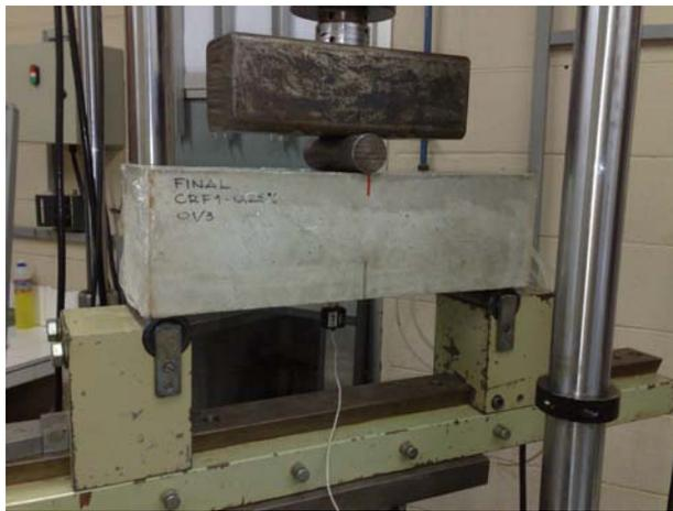
Figura 3.33 – Pré-trinca no corpo-de-prova
