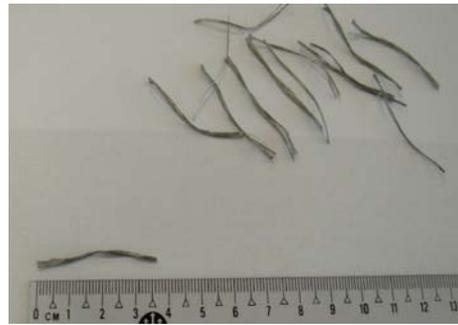
Figura 3.5 – Fibra 2 (polipropileno)
