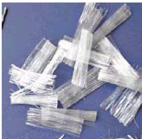
Figura 2.3 – Microfibras sintéticas (polipropileno)
