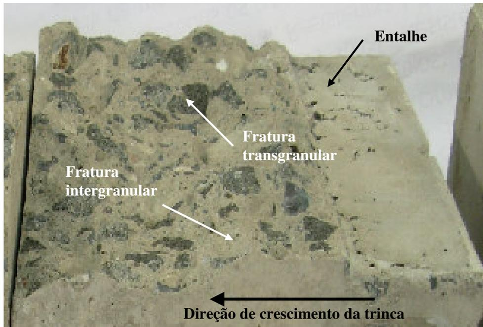
Figura 4.59 – Imagem da seção fraturada de corpo-de-prova de carga monotônica - CMOD do CR
