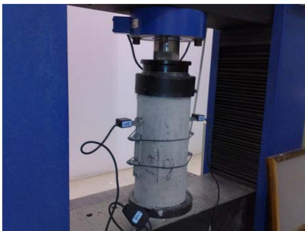
Figura 3.28 – Ensaio de compressão para obtenção do módulo de elasticidade
