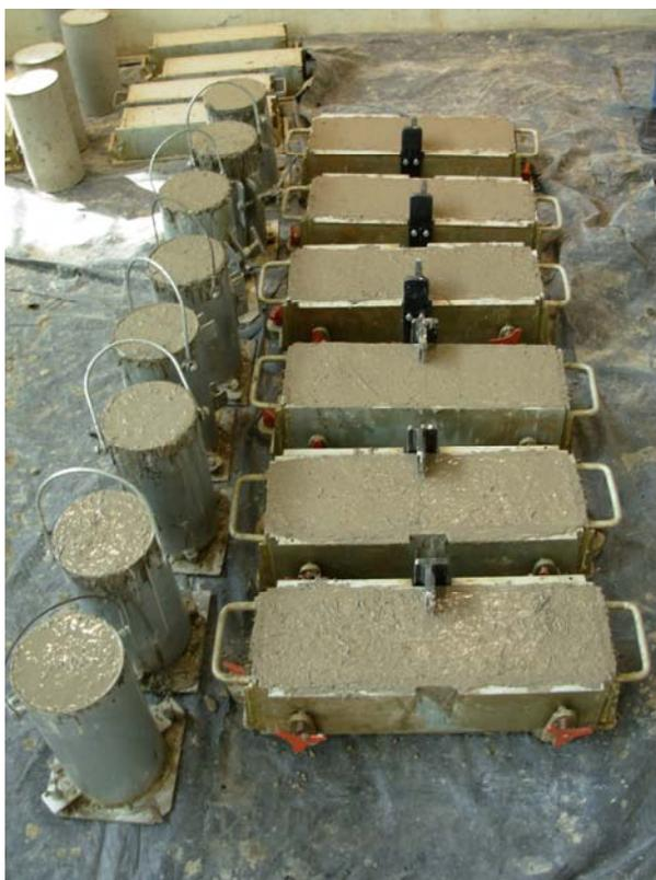
Figura 3.19 – Corpos-de-prova cilíndricos e prismáticos moldados
