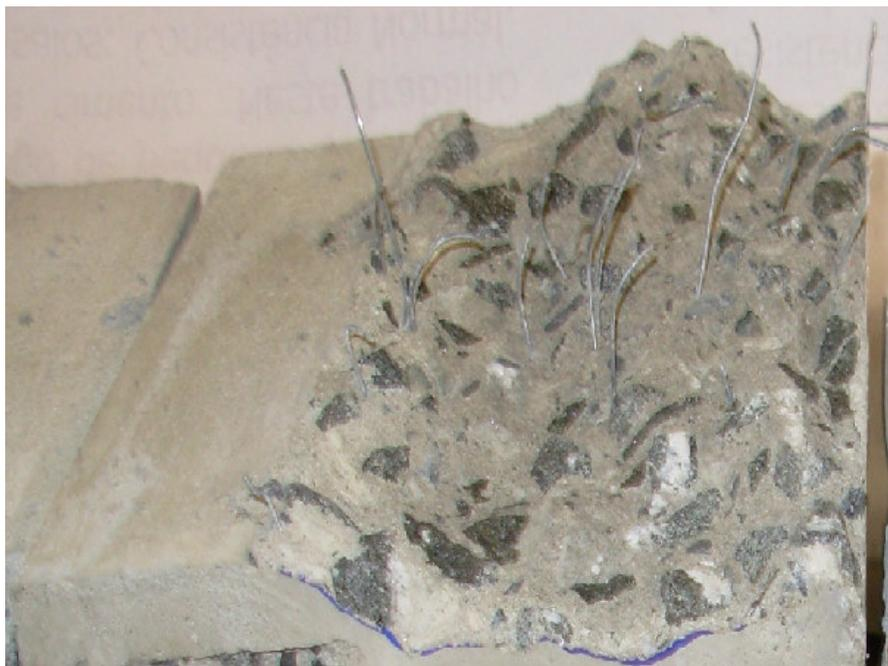
Figura 4.68 – Imagem da seção fraturada de corpo-de-prova de carga monotônica - CMOD do CRF4 0,38%
