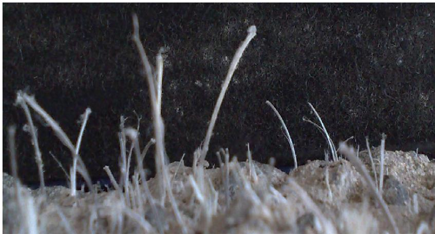
Figura 4.30 – Aspecto das fibras sintéticas com as pontas que atuam como ancoragem mecânica da fibra na matriz de concreto
