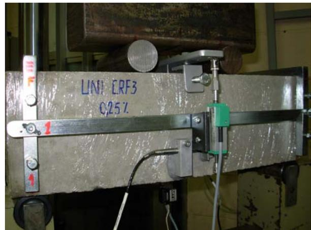
Figura 3.38 – Ensaio carga monotônica - CMOD
