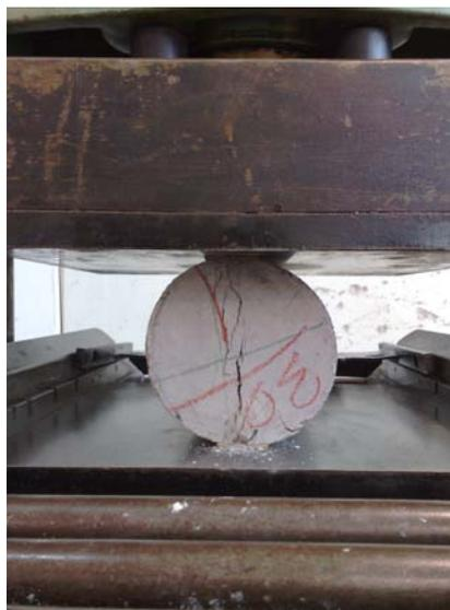
Figura 3.30 – Ensaio de compressão diametral para obtenção da resistência à tração
