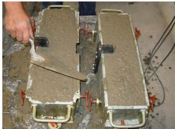
Figura 3.18 – Acabamento superficial da forma prismática
