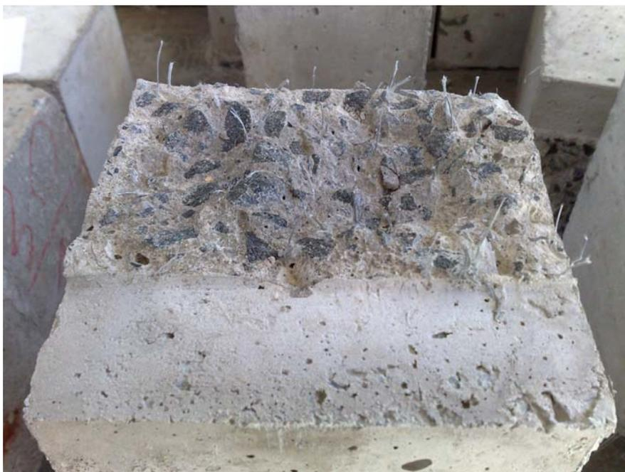
Figura 4.61 – Imagem da seção fraturada de corpo-de-prova de propagação de trinca por fadiga do CRF2 – 0,50%
