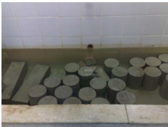
Figura 3.22 – Tanque de imersão para cura dos corpos-de-prova
