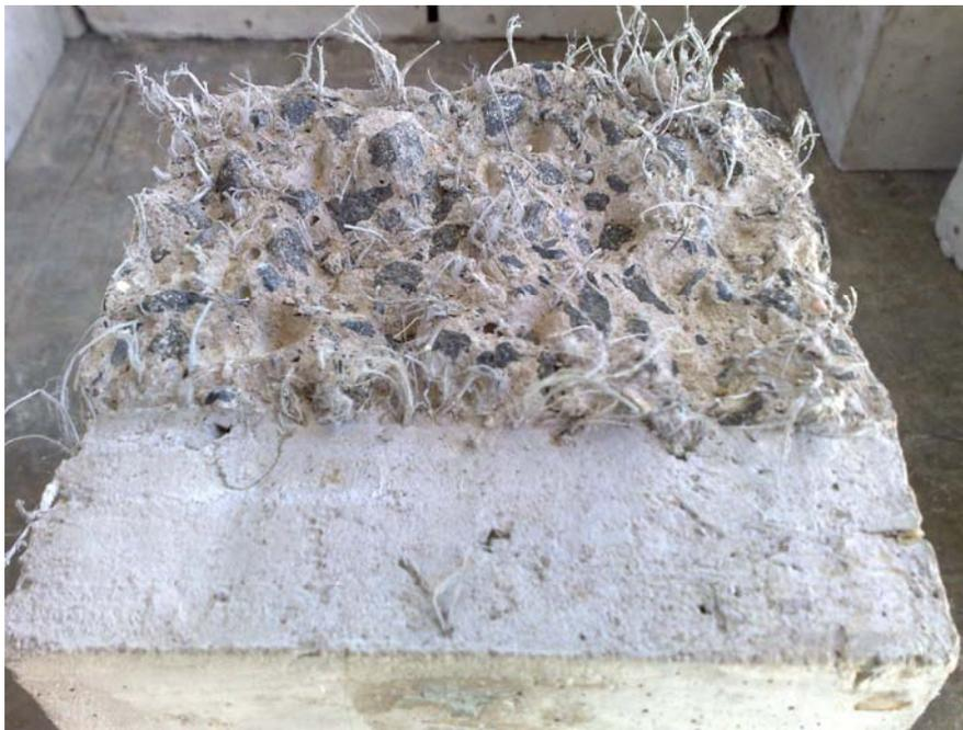
Figura 4.60 – Imagem da seção fraturada de corpo-de-prova de propagação de trinca por fadiga do CRF1 – 0,50%
