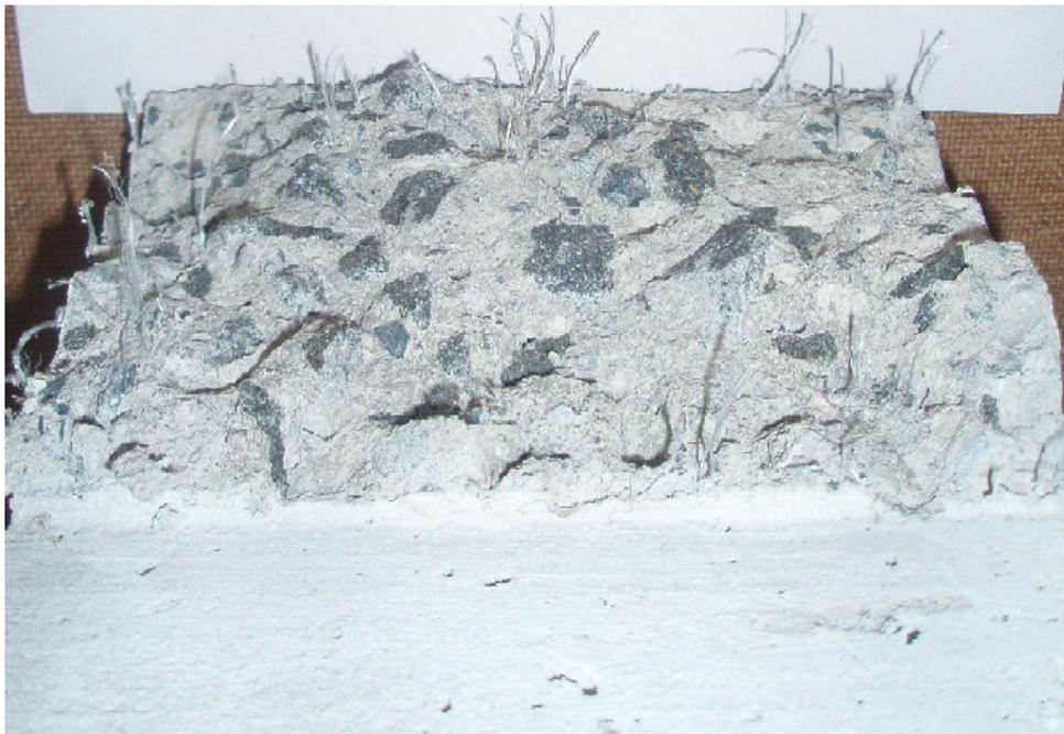
Figura 4.65 – Imagem da seção fraturada de corpo-de-prova de carga monotônica - CMOD do CRF1 0,38%
