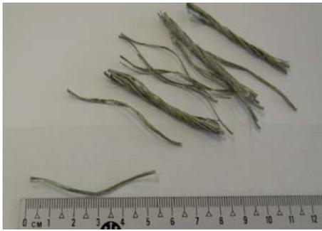
Figura 3.4 – Fibra 1 (polipropileno)
