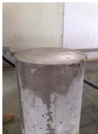
Figura 3.24 – Corpo-de-prova cilíndrico fresado
