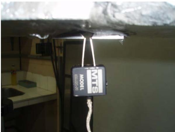
Figura 3.37 – “Clip-on-gauge” colocado na face inferior do corpo-de-prova
