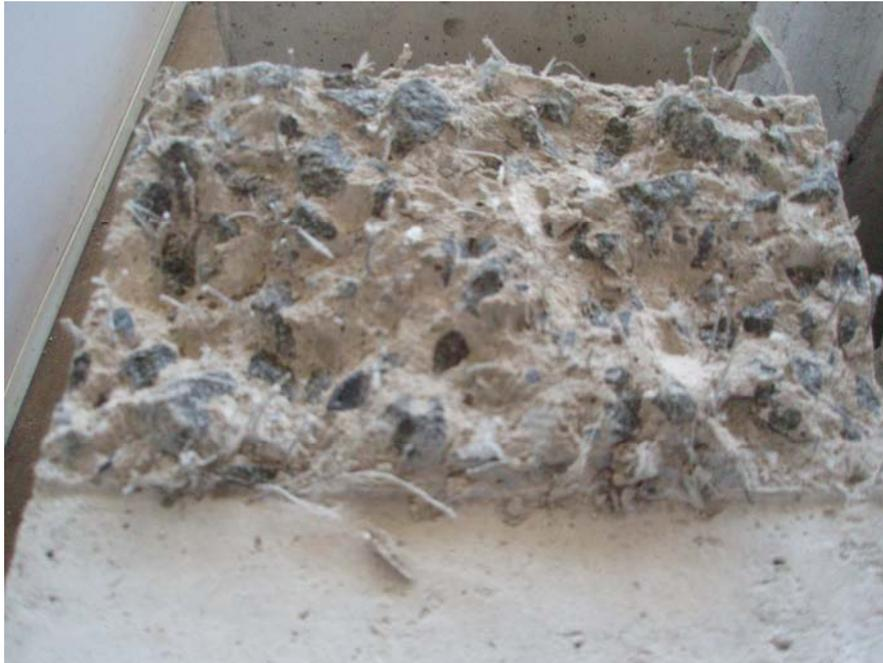
Figura 4.66 – Imagem da seção fraturada de corpo-de-prova de carga monotônica - CMOD do CRF2 0,38%
