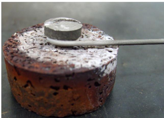
Figura 3.8. Contato no eletrodo esponja para anodização
