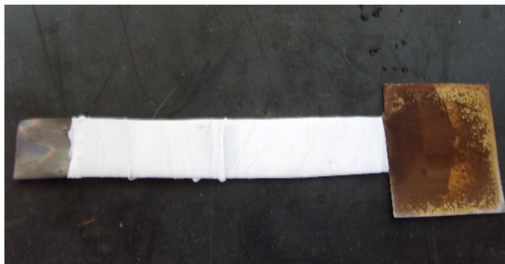
Figura 3.4. Formato dos eletrodos para os estudos voltamétricos.
