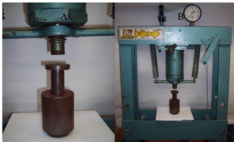
Figura 3.6 Molde cilíndrico (A), prensa hidráulica (B).
