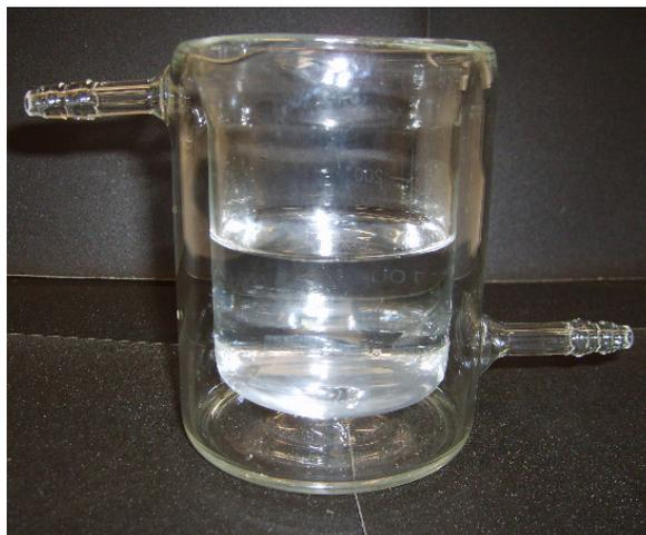
Figura 3.5 Célula de compartimento único encamisada
