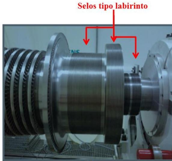
Figura 1: Exemplos de selos de fluxo do tipo labirinto em turbinas.
