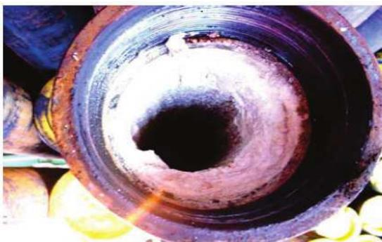
Figura 4.7: Exemplo da deposição de  $BaSO_4$  em uma coluna de produção no Campo de Namorado (SILVA et al., 2007)
