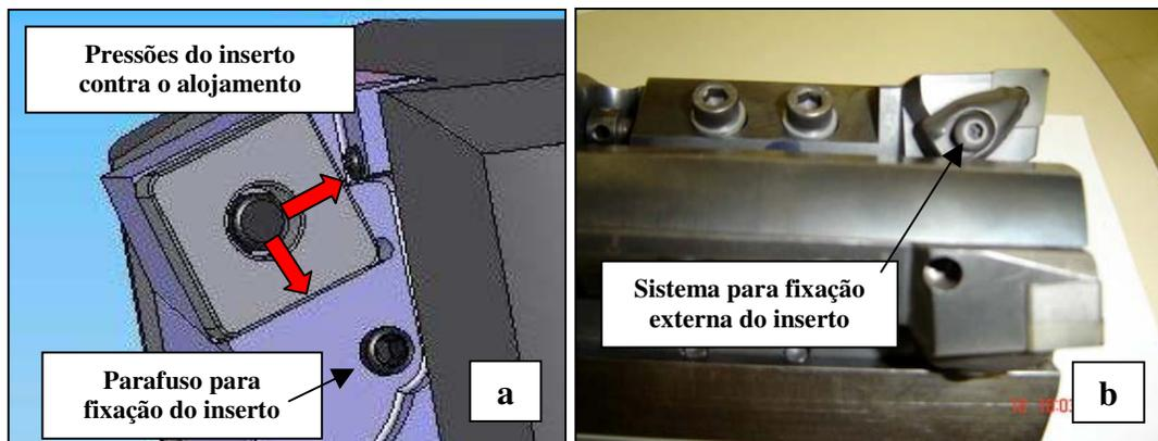
**Figura 3.18** - Sistemas de fixação dos insertos anterior (a) e atual (b).
