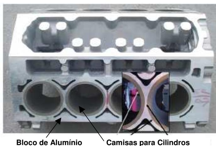
**Figura 2.13** - Bloco de alumínio para motor automotivo com camisas para cilindros (Carrera et. al, 2007).
