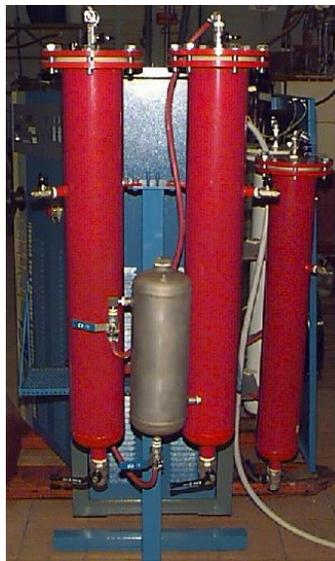
Figura 3.5 – Sistema de secagem e remoção de oxigênio
