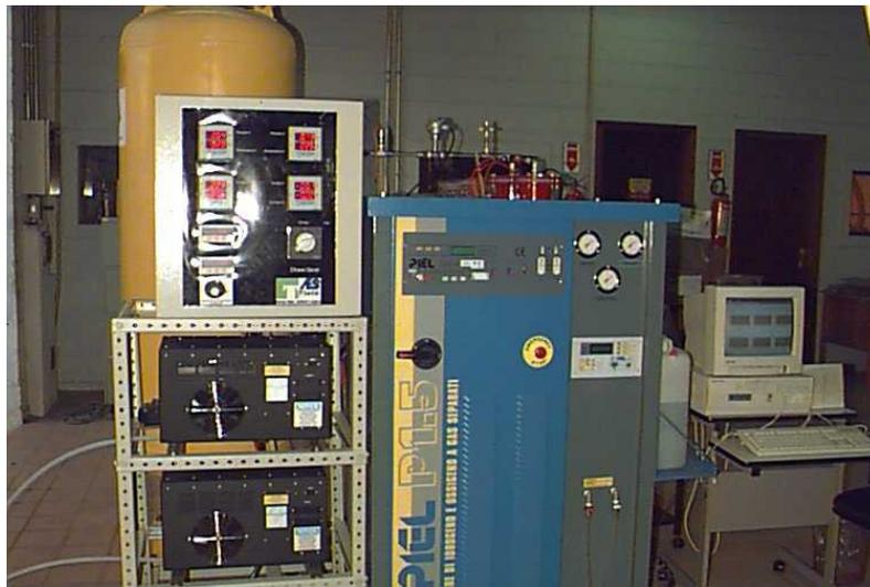
Figura 3.2 – Foto do sistema completo de produção e reconversão de hidrogênio em energia elétrica
