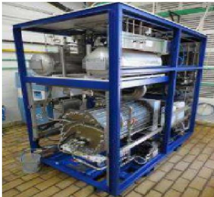
Figura 2.2: Eletrolisador alcalino da empresa Nitidor
