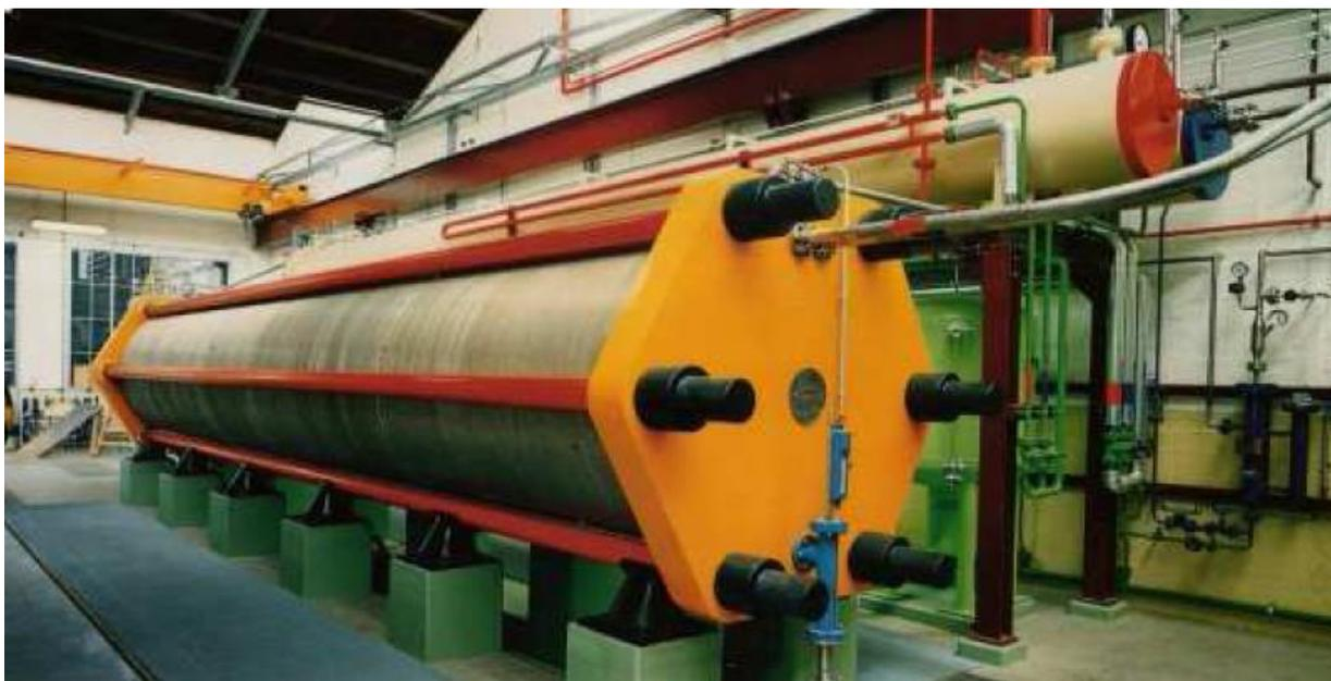
Figura 3.2 - Eletrolisador bipolar alcalino da empresa *ELT*.
