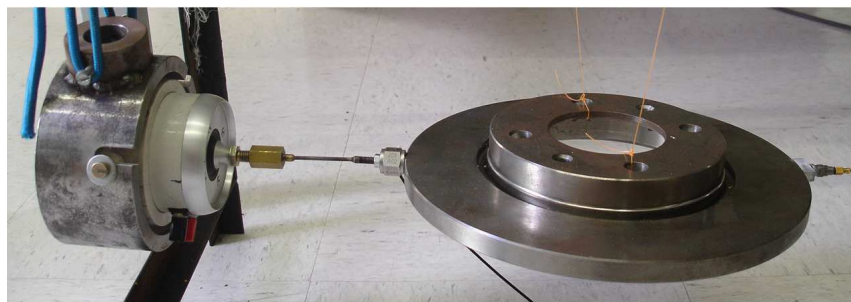
Figura 4.9: Foto da Excitação Radial do Disco de Freio
