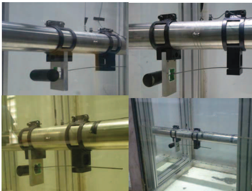
Figura 3.17: Absorvedor de Vibrações PTMD acoplado ao corpo de provas.
