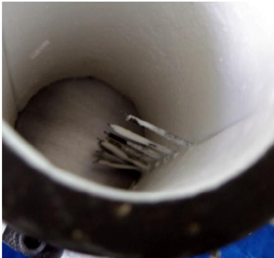
Figura 3.3. Vista superior da lingoteira montada mostrando o posicionamento dos termopares.
