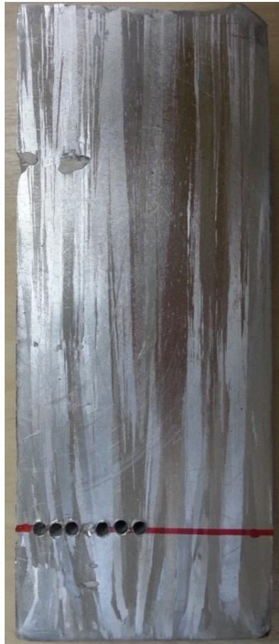
Figura 3.7. Retirada de cavacos para análise da composição química.
