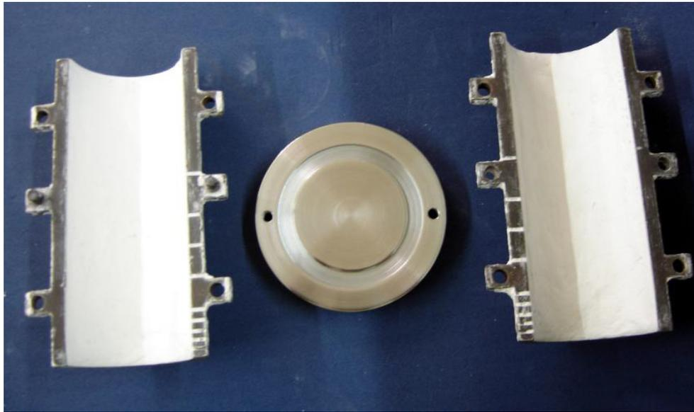
Figura 3.2. Lingoteira e chapa molde, ambas em aço inoxidável, utilizadas na solidificação ascendente.
