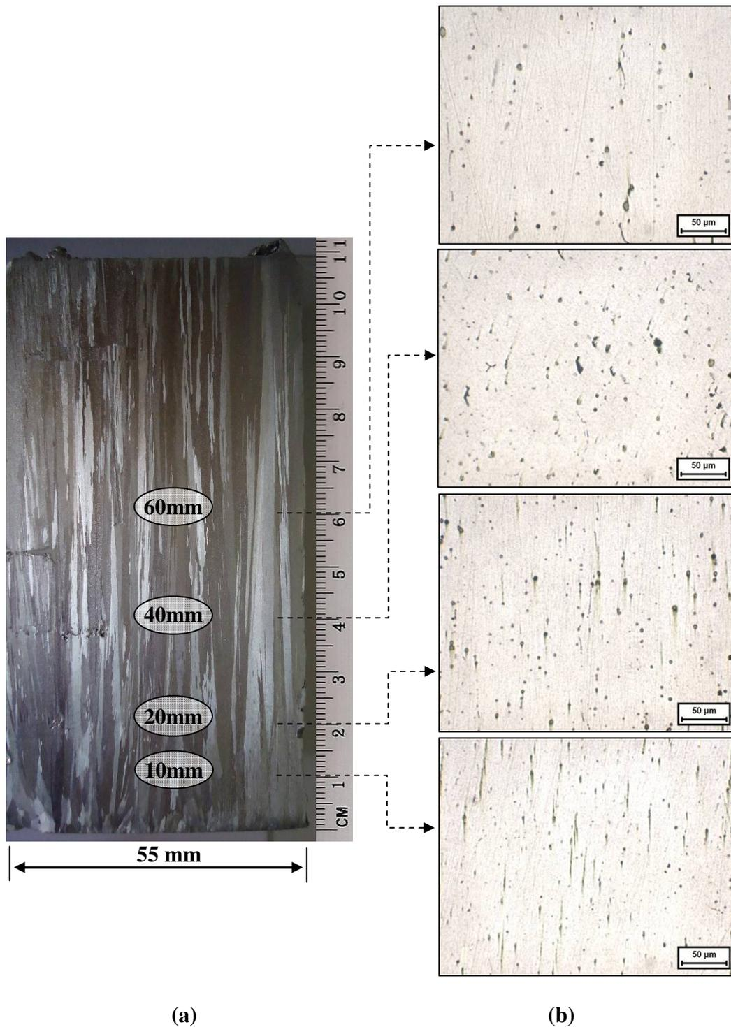
(a) Macroestrutura, (b) microestruturas longitudinais da liga Al-3,2% Bi solidificada no dispositivo vertical ascendente.
