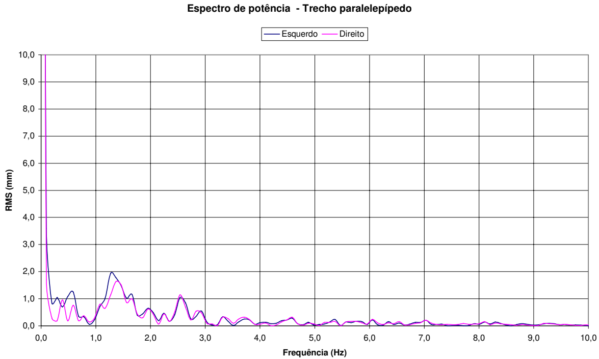
Figura 4.18: Espectro de potência do trecho em paralelepípedo.
