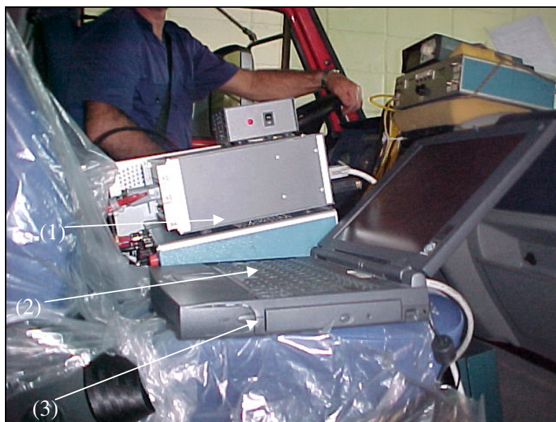
Figura 3.14: Sistema de aquisição de dados instalado no veículo.
