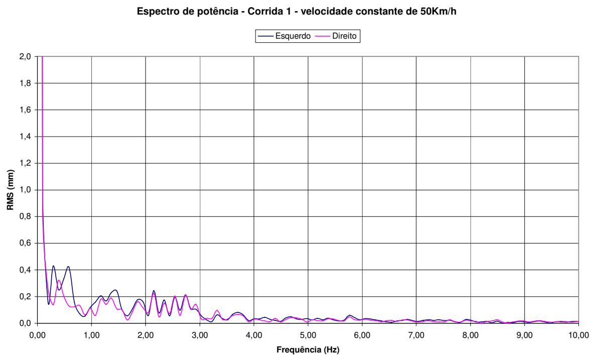
Figura 4.27: Espectro de potência do trecho em velocidade constante da corrida 1.
