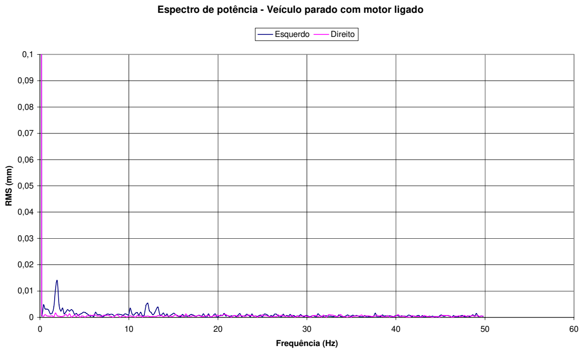
Figura 4.14: Espectro de potência dos deslocamentos com o veículo parado.
