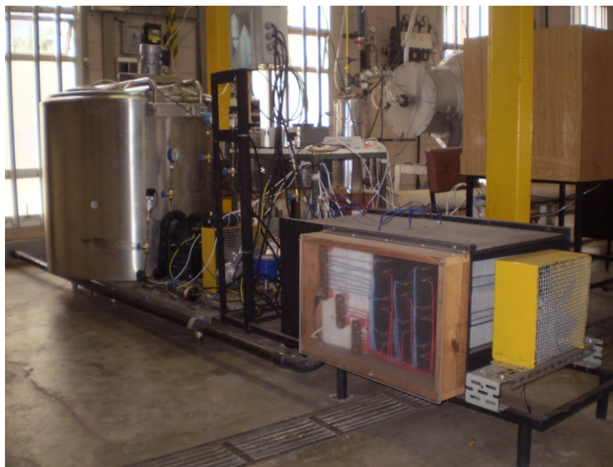
Figura 3.2: Fotografia do sistema experimental contendo mini-tanque de resfriamento de leite
