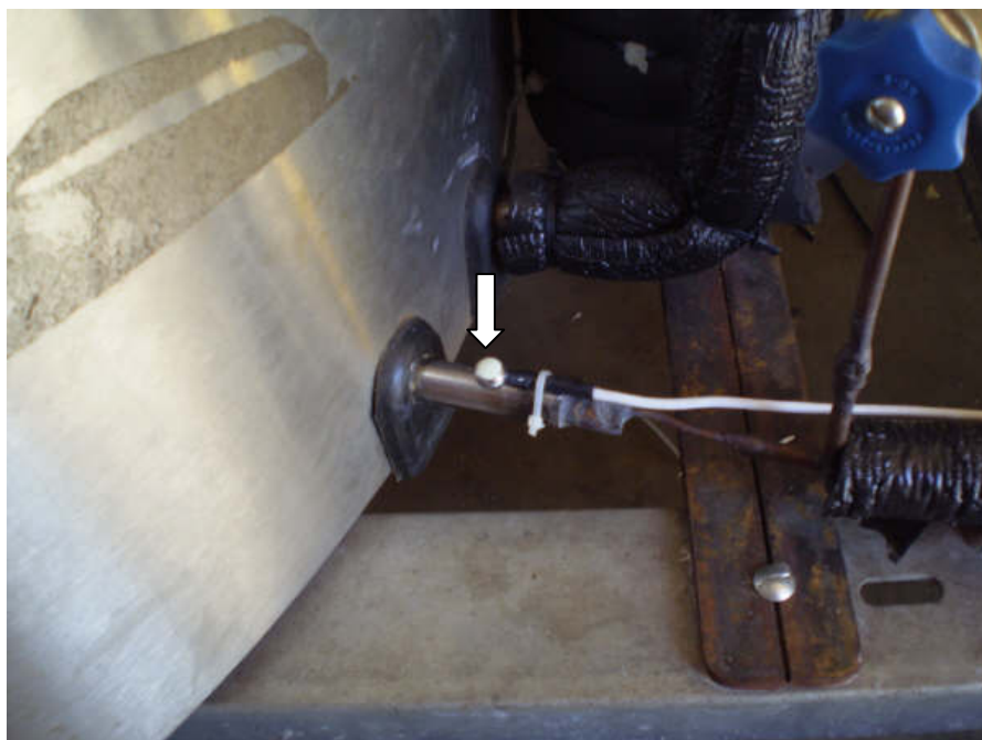
Figura 3.6: Fotografia do modelo de PT-100 utilizado para a obtenção das medidas de temperatura
