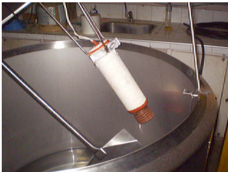
Figura 3.5: Fotografia da resistência elétrica localizada no interior do tanque
