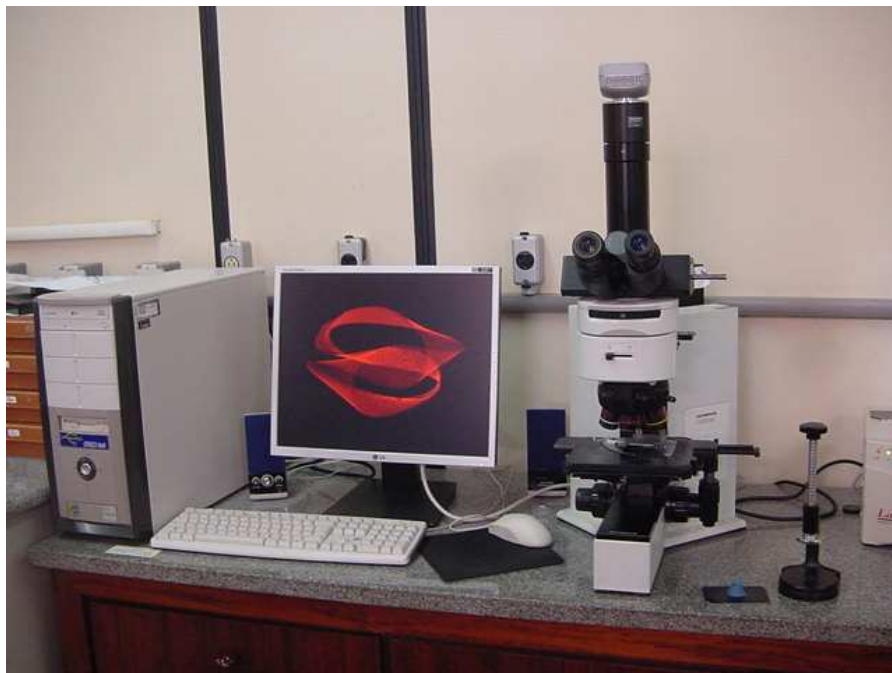
Figura 3.8- Microscópio de luz refletida modelo Olympus BX 60M do Laboratório de Solidificação Controlada – FEM, onde as imagens metalográficas foram capturadas para análise.
