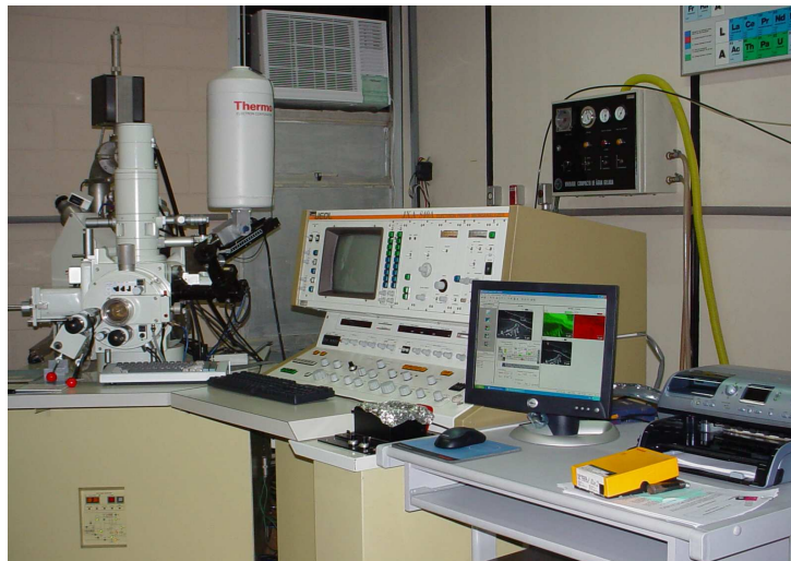
Figura 3.10- Microscópio JEOL, modelo JXA 840-A do Departamento de Engenharia de Materiais – FEM, cuja interação do seu feixe com a amostra geram muitos sinais que podem ser usados para produzir uma imagem e realizar a microanálise do material.
