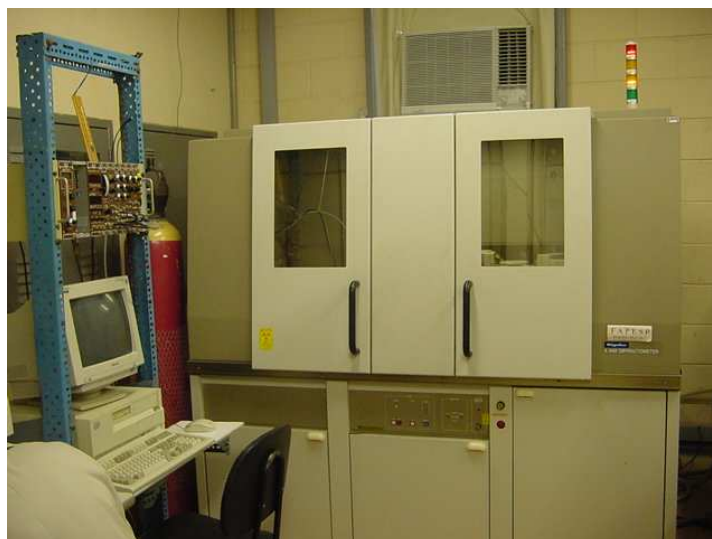
Figura 3.4- Difratorômetro da marca Rigaku do Departamento de Engenharia de Materiais – FEM, com tubo de cobre ( \lambda = 1,5418 \text{ \AA} ), tensão aplicada de 50 kV e corrente de 20 mA, utilizado para a identificação das fases com auxílio de um banco de dados JCPDS (Joint Committee for Power Diffraction Standards)
