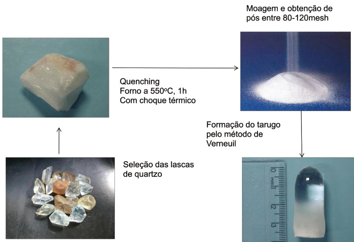
**Figura 3.2- Sequência de procedimentos para a produção de sílica vítrea por fusão em chama a partir de pós de quartzo natural.**
