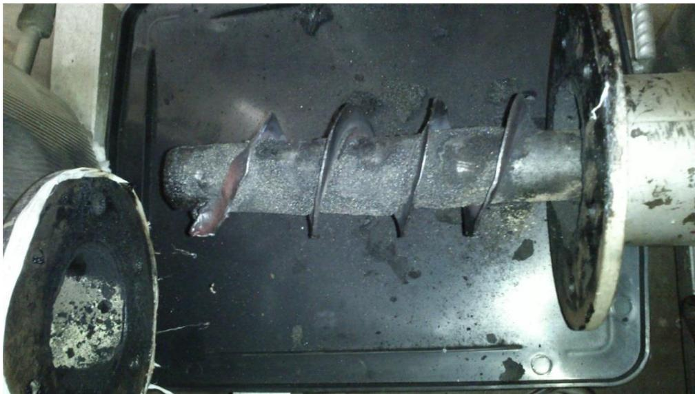
Figura 4.10 Areia fundida aderida ao eixo do alimentador
