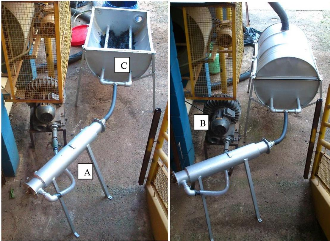
Figura 3.6 Secador de lodo construído. A) Trocador de Calor; B) Ventilador; C) Tonel para secagem aberto.
