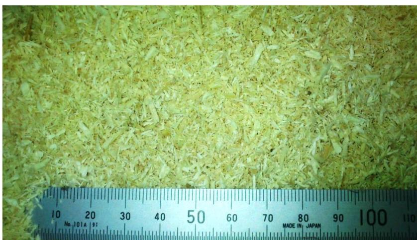
Figura 4.2 Serragem de *pinus* moída pronta para uso no reator. Fonte: o autor
