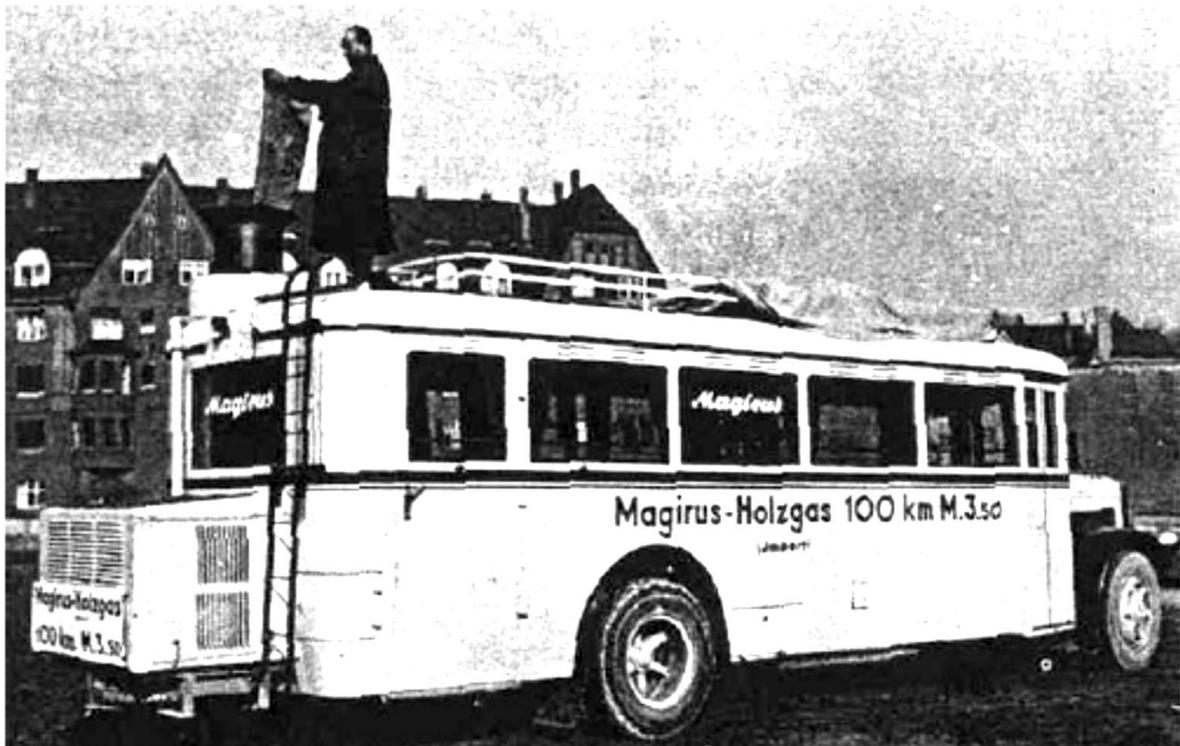
Figura 2.5 Veículos com gaseificador portátil utilizados no período da segunda guerra. Fonte: <http://biomassenergyfndn.org/bef/organization-history/>
