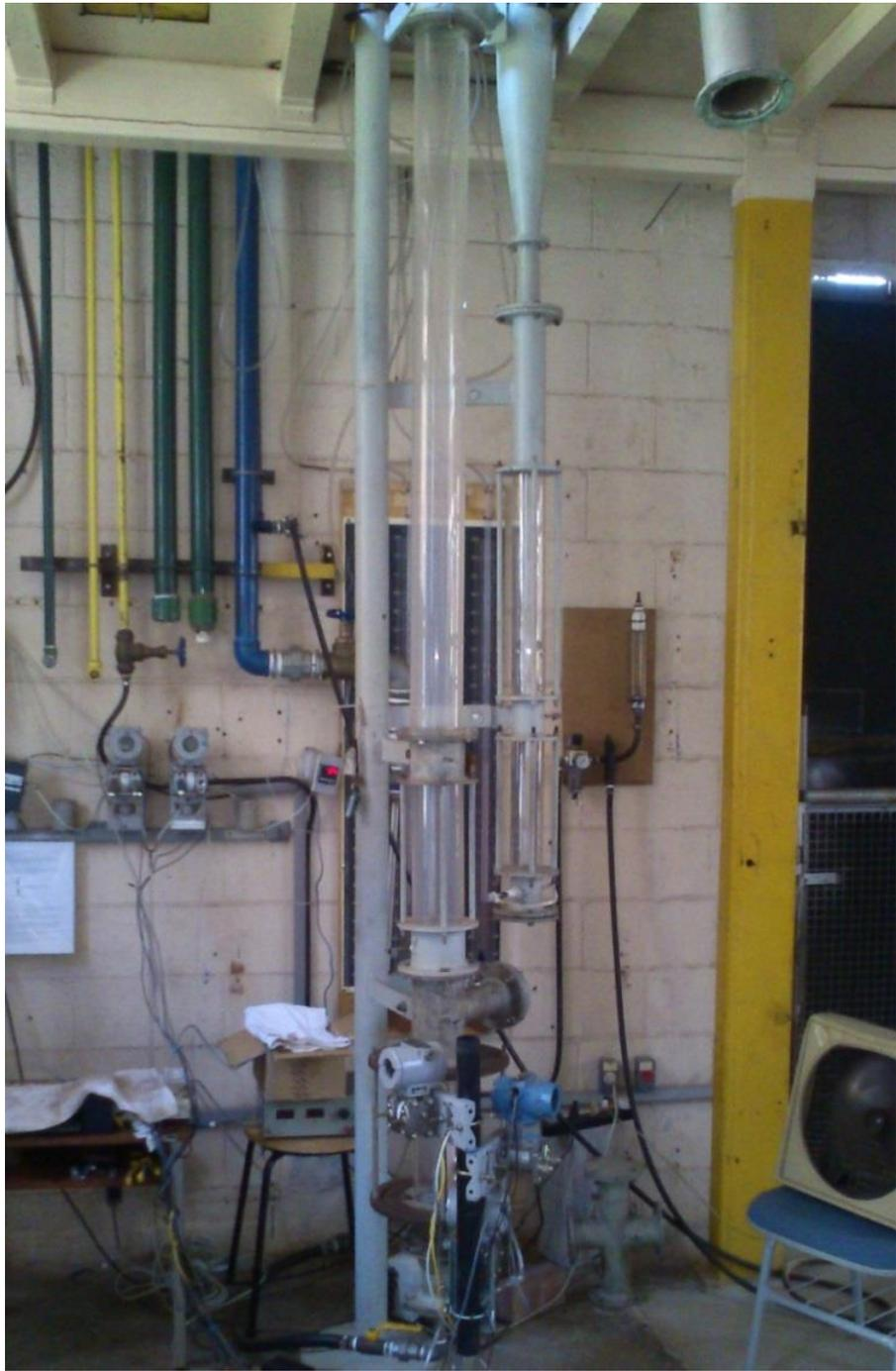
Figura 3.7 Dispositivo para testes de fluidização a frio
