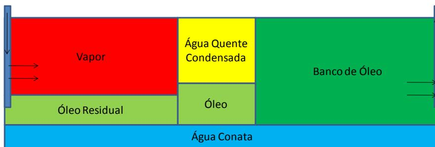
Figura 1. Esquema da injeção contínua de vapor.
