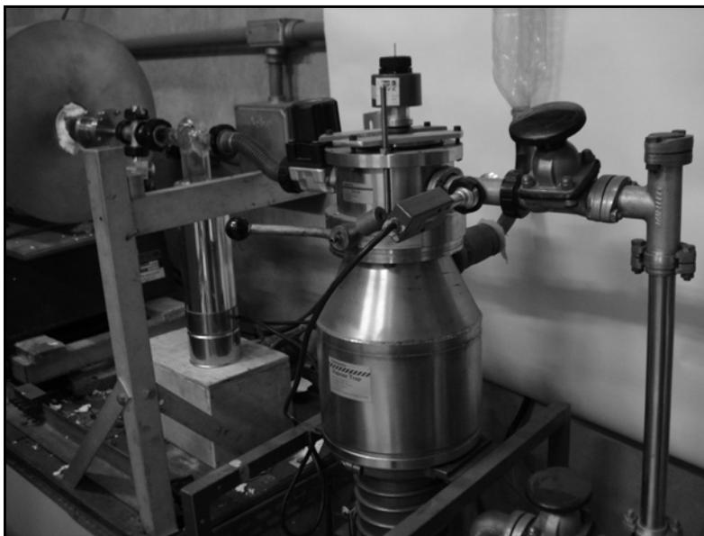
**Figura 3.2** – Forno tubular a vácuo.
