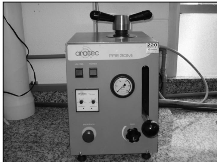
**Figura 3.4** – Embutidora metalográfica PRE 30Mi e 40Mi.
