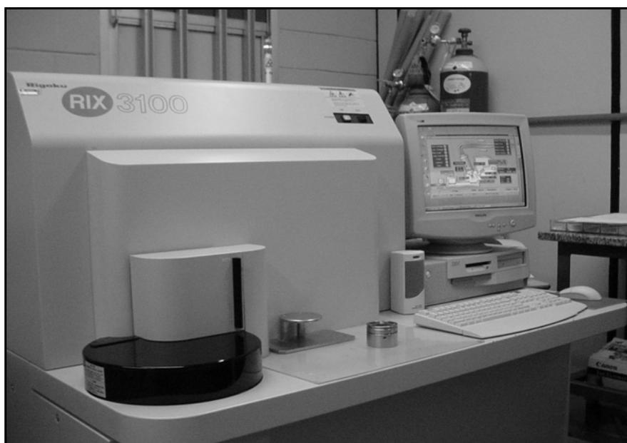
**Figura 3.9** – Espectrômetro de fluorescência de raios X.
