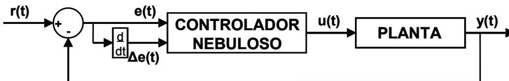
Figura 4.16. Processo controlador por sistema nebuloso com entradas Erro e Derivada do Erro.
