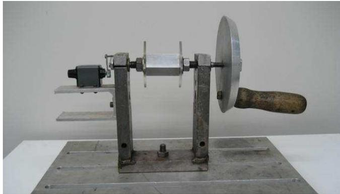
Figura 6.1 – Máquina manual para enrolamento de bobinas.
