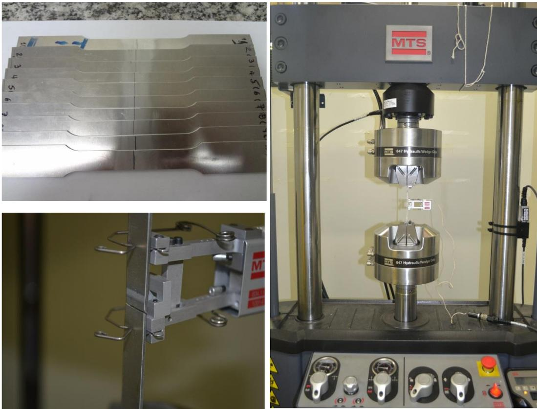
Figura C.4 Corpos de prova com solda FSW da matriz 2 condição 1; sensor MTS no teste; e equipamento MTS para os ensaios de tração.
