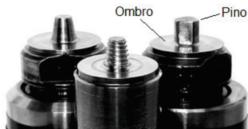
Figura 1.3 - Ferramentas do processo FSW (Capelari e Mazzaferro (2009), modificada).
