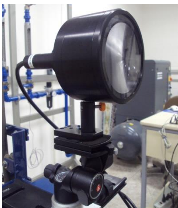
Figura 23: Imagem do Difusor de luz – acoplado ao laser por fibra óptica.
