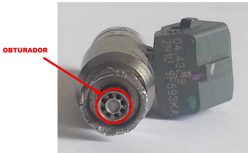
Figura 6: Obturador do atomizador – função de causar turbilhonamento no líquido e formar o spray cônico.
