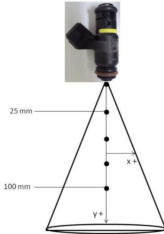
Figura 36: Distâncias axiais do bico injetor.
