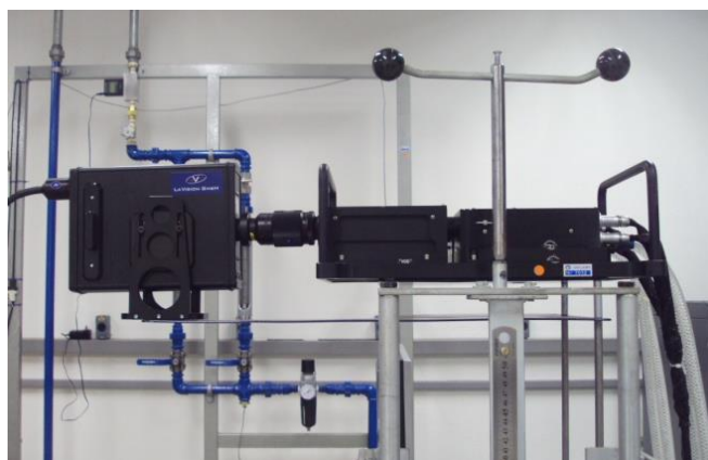
Figura 21: Imagem do sistema laser Nd:YAG – ‘cabeça’ do laser por onde a luz é emitida e enviada ao difusor por fibra óptica.
