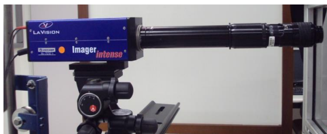
Figura 24: CCD câmera Imager Intense com lente 12X Ultra Zoom Lens .
