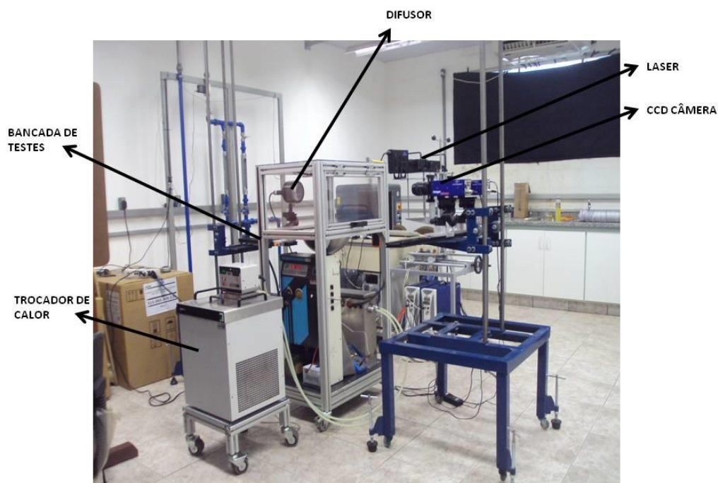
Figura 26: Disposição final dos equipamentos.
