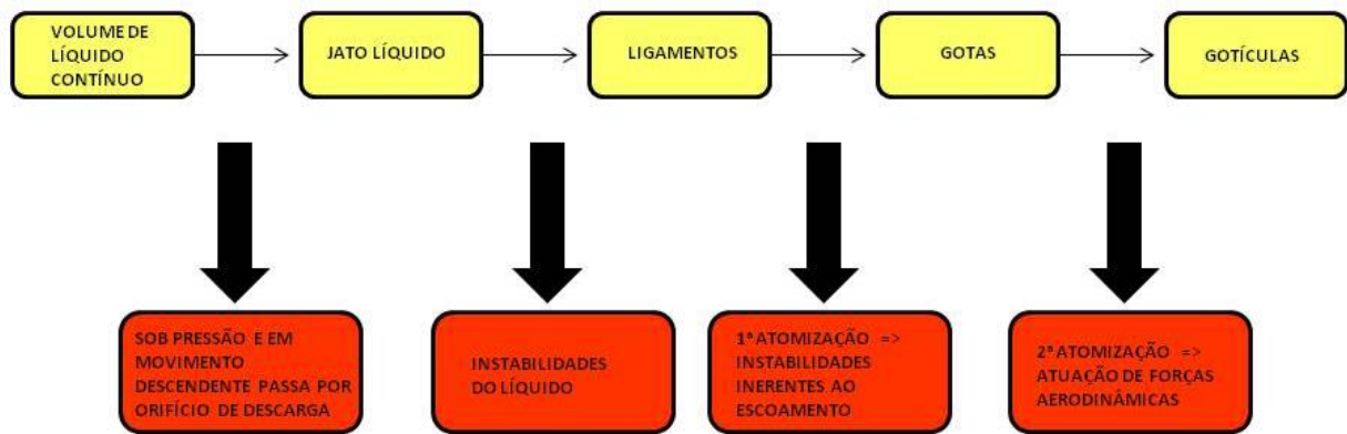
Figura 7: Fluxograma da atomização em um atomizador mecânico-centrífugo.
