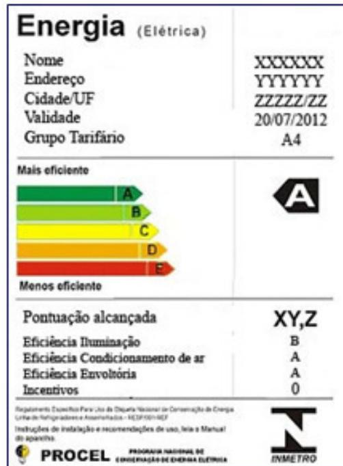
**Figura 2.7. Etiqueta do PROCEL para eficiência energética de edificações.**
