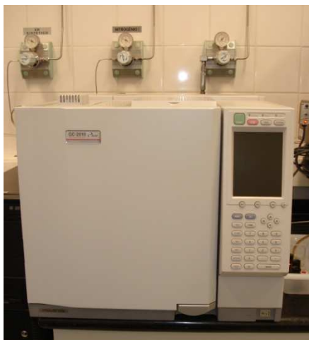
Figura 3.6 Cromatógrafo utilizado na caracterização das frações parafínicas.
