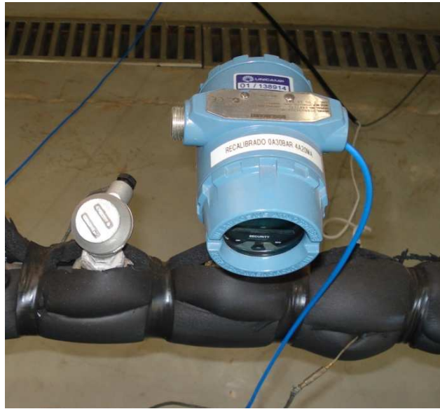
Figura 3.19 Manômetro e termopar acoplados à linha próximo a entrada da seção de teste.
