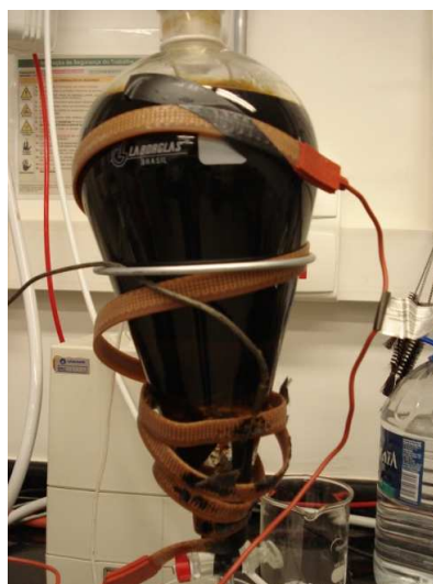
Figura 3.3 Funil de separação com a mistura de óleo sendo aquecido pela cinta térmica.
