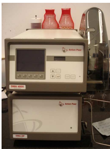
Figura 3.7 Densímetro DMA 4500 utilizado para as medidas de densidade do óleo.
