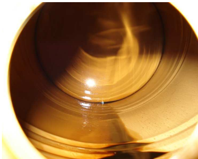
Figura 3.5 Imagem da parte interna de um galão de 50 L após retirada do óleo cru, que foi submetido ao procedimento de aquecimento e agitação durante 8 horas.
