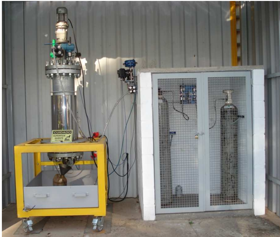
Figura 3.18 No lado esquerdo o tanque de óleo externo, no centro a válvula elétrica pneumática e no lado direito o sistema de pressurização.
