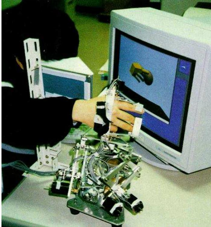
**Figura 3.1** – Usuário controlando uma mão virtual através de um exoesqueleto (Iwata, 1990).
