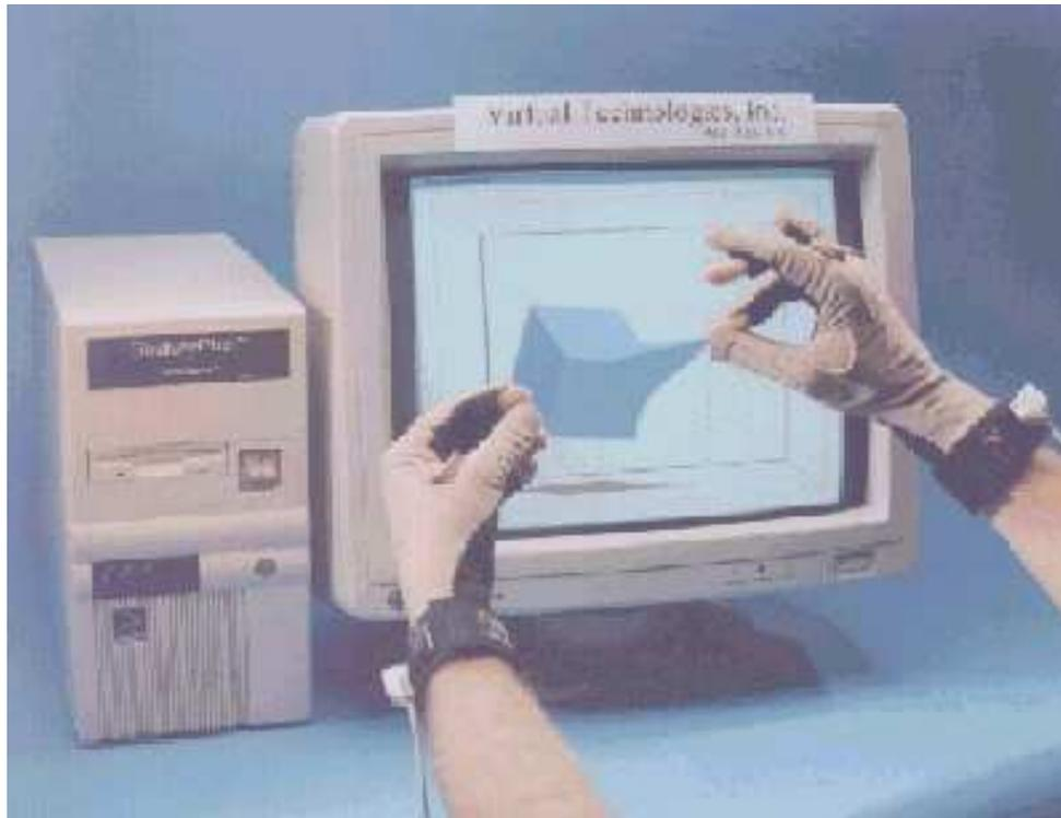
**Figura 2.10** – Usuário interagindo com um objeto tridimensional através de um dispositivo háptico (Fonte: <http://www.ul.ie/~idc/hci/lecture07/lecture07.html>) (acessado dia 28/10/2008)
