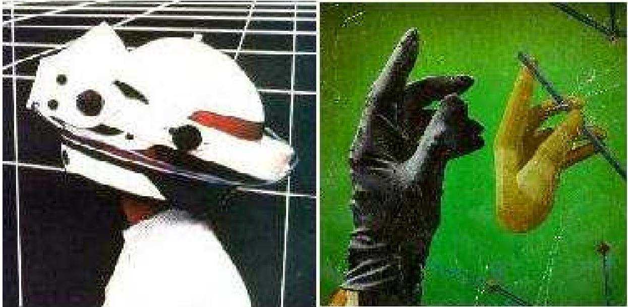
**Figura 2.3** - Esquerda - Usuário com a “Head-mounted” ; Direita - Luva vestida por usuário para interagir com ambiente virtual
