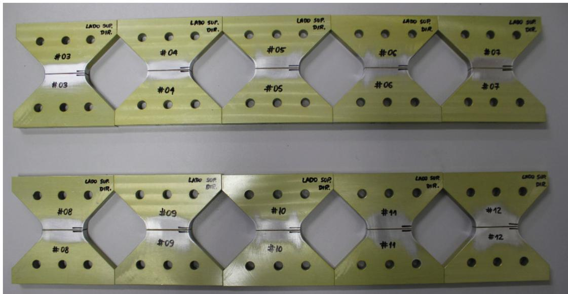
Figura 4.38 – Corpos de prova Arcan
