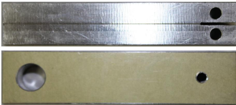
Figura 4.34 – *DCB's* improvisadas para calibração da técnica de medição de trinca
