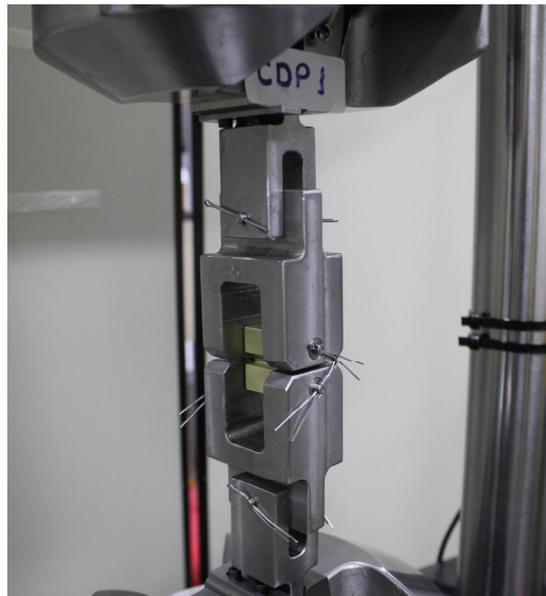
Figura 4.25 - Fixação do CDP de clivagem à máquina de ensaios
