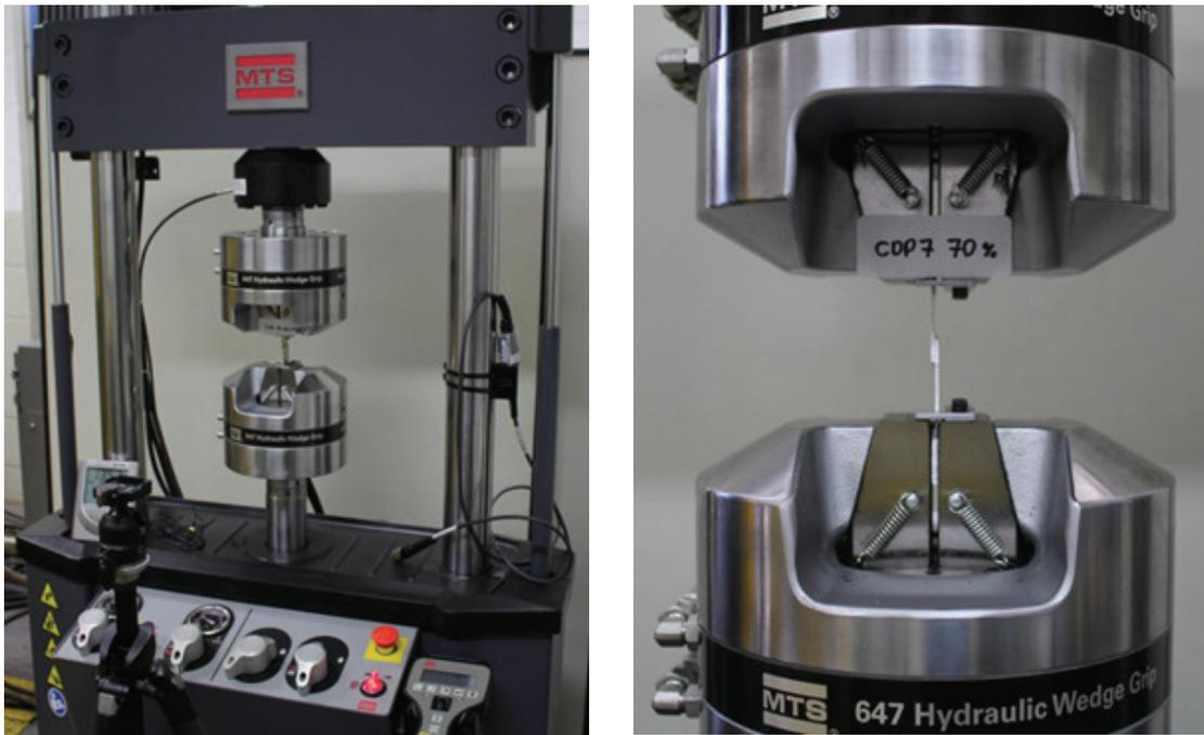
Figura 4.22 – Montagem dos CDP's na MTS
