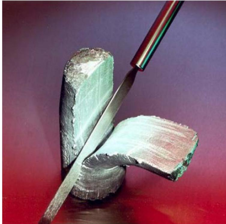
Figura 2.4: Lingote de Alumínio no estado semi-sólido (VINARCIK, 2002)
