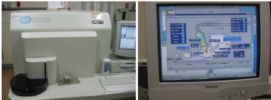
Figura 3.7 - Espectrômetro de fluorescência de raios-X marca Rigaku, modelo RIX 3100, empregado na análise química das amostras.
