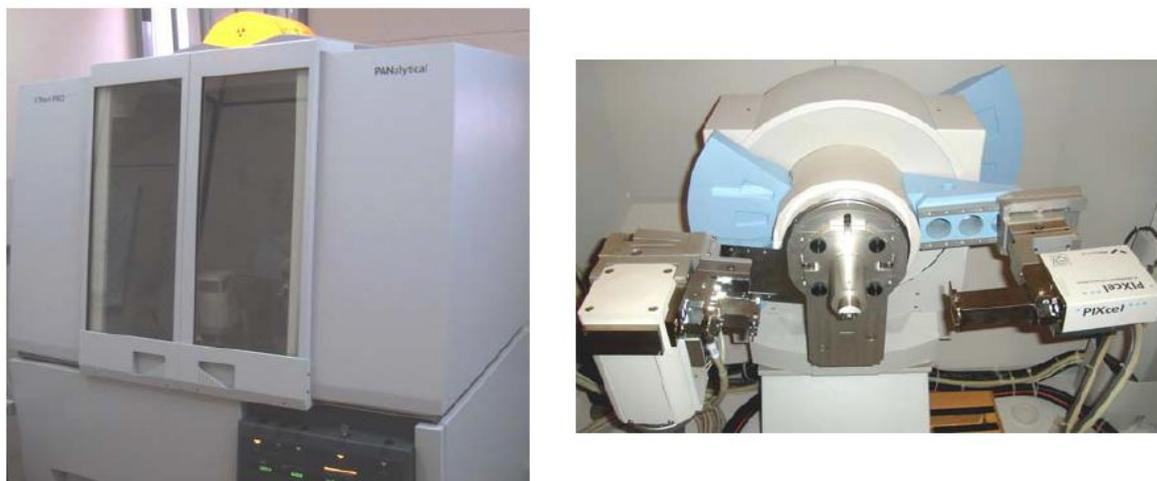
Figura 3.10 – Difratômetro de raios-X Panalytical X'pert PRO e detector PIXcel ultra rápido
