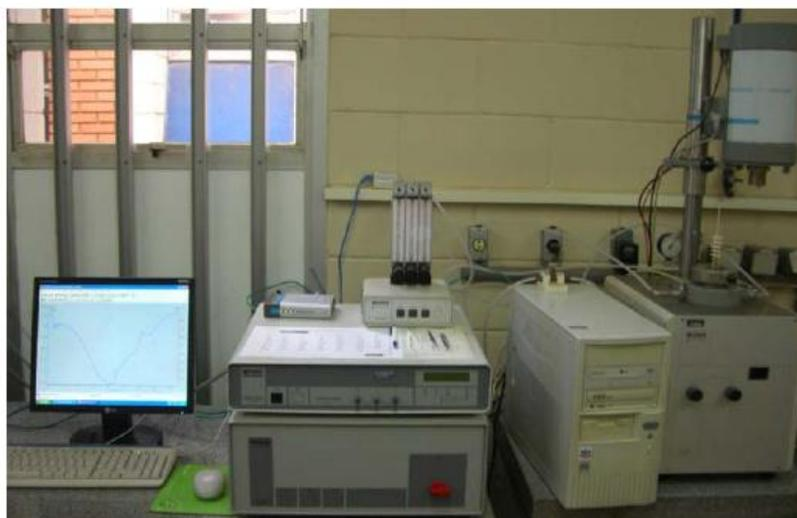
Figura 3.8 – Sistema de análise térmica Netzsch STA 409.
