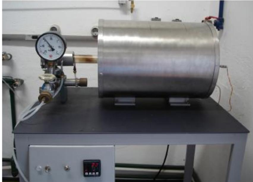
Figura 3.5 - Forno de tratamento térmico utilizado no procedimento BASCA.
