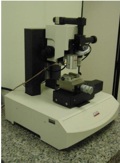
Figura 3.13 - Nanoindentador marca CSM Instruments, modelo Nano-Hardness Tester usando indentador de diamante do tipo Berkovick.
