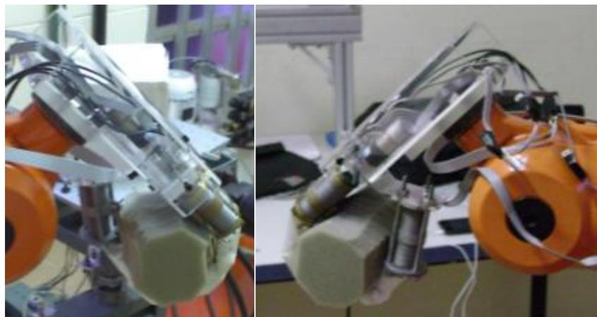
Figura 6.6: Preensão cilíndrico com todos os dedos
