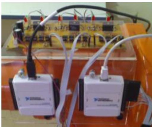
e) Interfaces de aquisição de dados e potencia.
