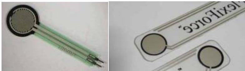
Figura 5.13: Sensor *FlexiForce*<sup>TM</sup> (Imagem de um FSR)
