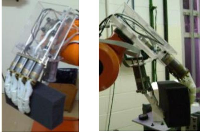
Figura 6.7: Preensão elemento cúbico com todos os dedos
