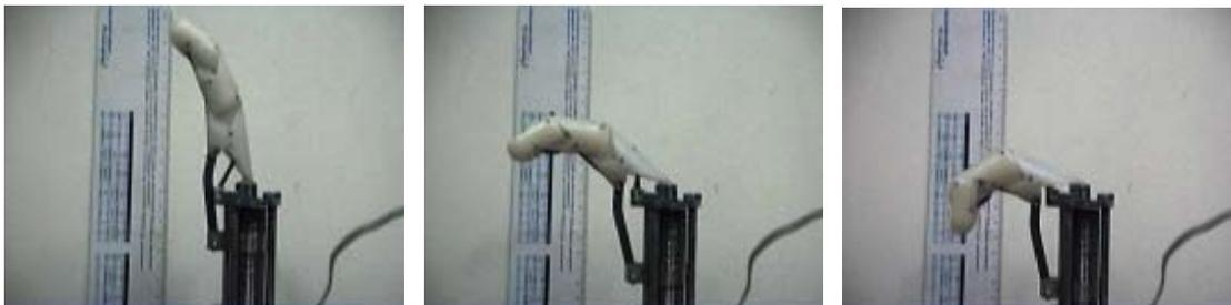
Figura 5.10: Sequência de movimento do dedo mecânico.
