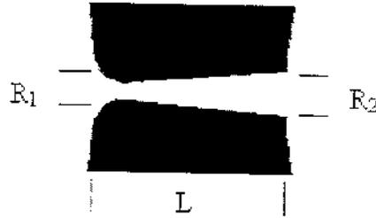
Figura 3.7: Representação do difusor utilizado na microbomba.  $R_1=100 \mu m$ ;  $R_2=500 \mu m$ ;  $L=2.3 \text{ mm}$ . A curvatura da entrada menor do difusor é de  $100 \mu m$ .
