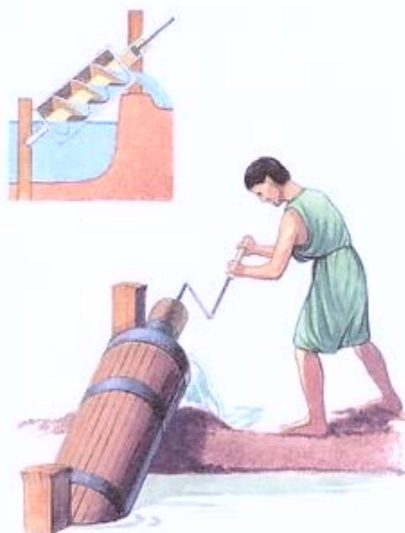
Figura 2.2: Bomba parafuso de Archimedes
