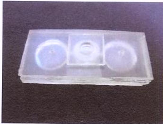
Figura 4.10: Microbomba construída
