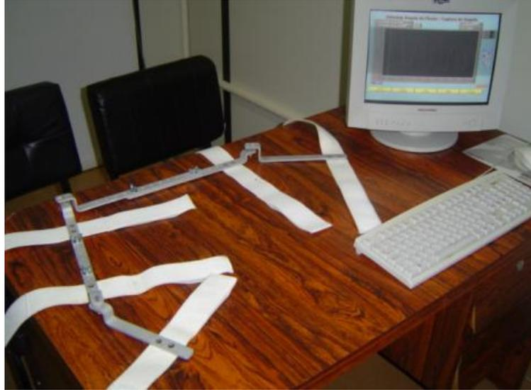
Figura 4. 1: Eletrogoniômetro conectado ao software Labview (interface).
