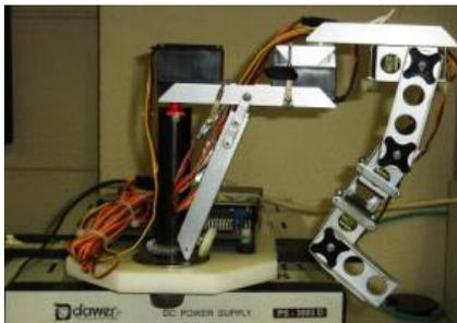
Figura 4. 13: Servo-sistema com configuração geométrica antropomórfica bípede.
