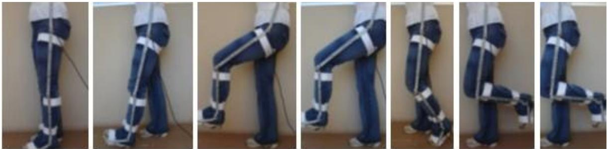
Figura 4. 2: Detalhe da disposição do eletrogoniometro no membro a ser avaliado em um processo de marcha.
