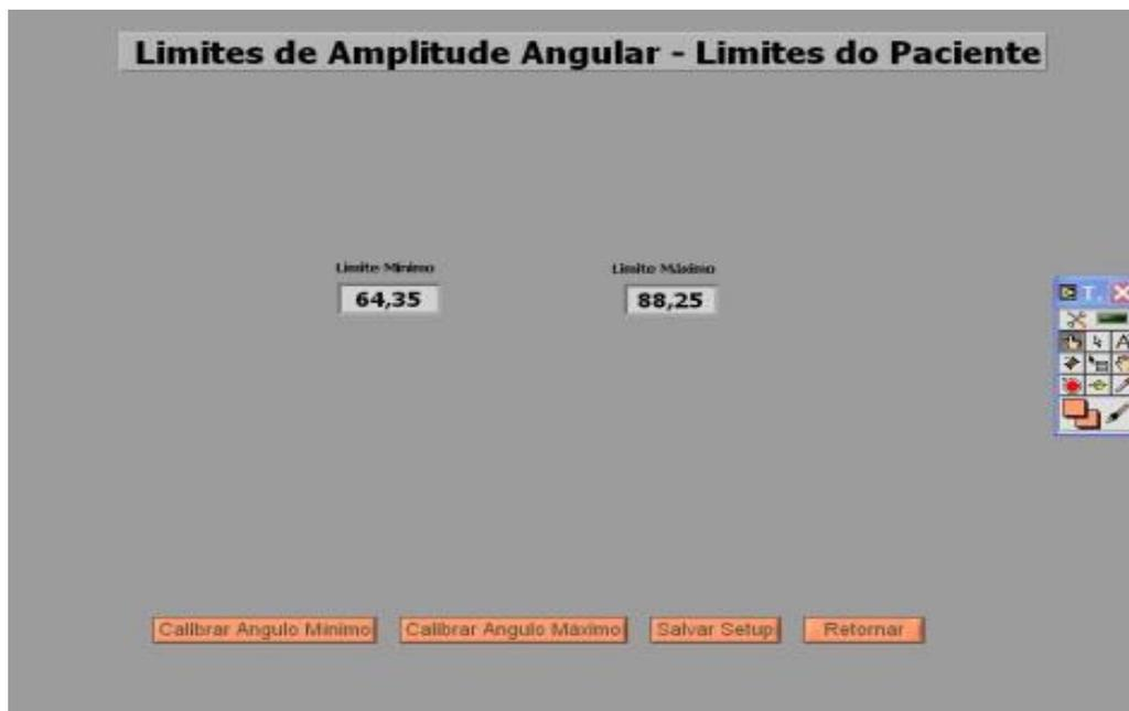
Figura 4. 5: Calibração dos limites articulares máximo e mínimo do quadril.
