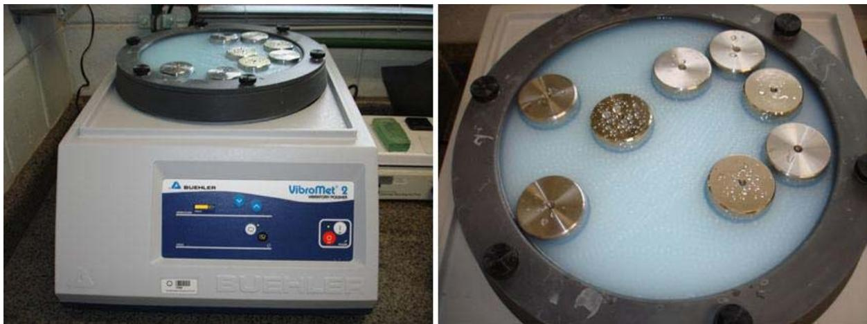
Figura 3.3 - Equipamento de polimento VibroMet.
