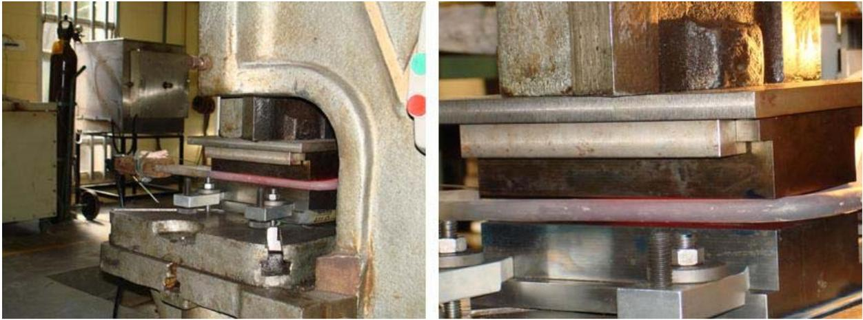
Figura 3.10 - Resistência elétrica empregada no aquecimento das matrizes.
