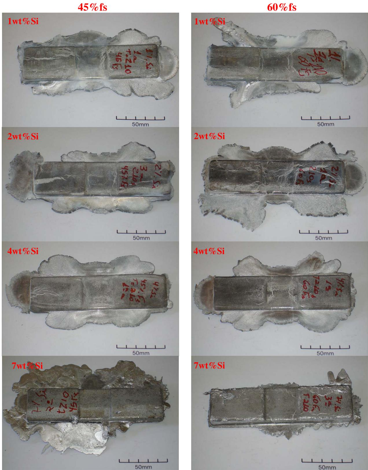
Figura 4.24 - Peças tixoforjadas com 45% e 60%fs com  $t_{GL}$  de 210s.
