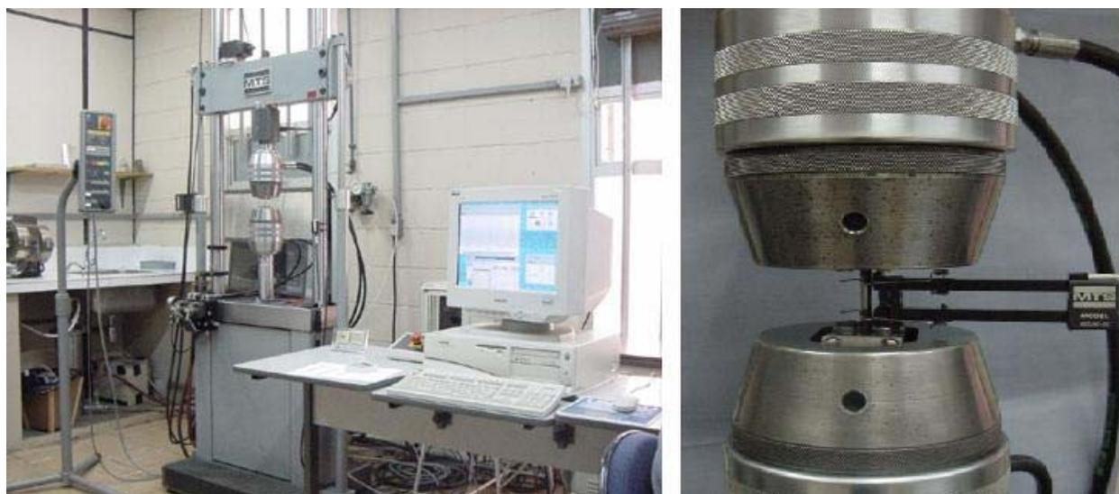
Figura 3.13 - Equipamento MTS e fixação do corpo de prova de tração.
