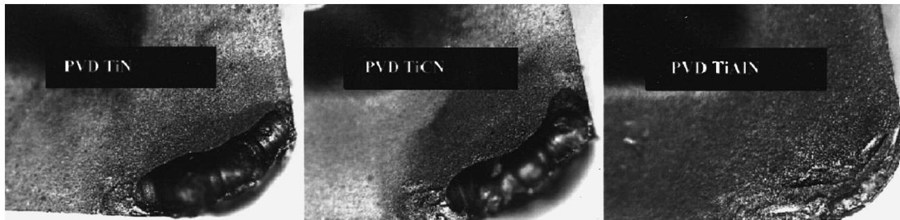
**Figura 2.25 - Desgaste de cratera na usinagem de ferro fundido nodular com velocidade de 244 m/min após 2 minutos de torneamento (JINDAL *et al.*, 1998).**
