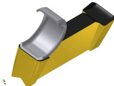
**Figura 2.17- Deformação do cavaco em dois eixos no corte com bedames.**
