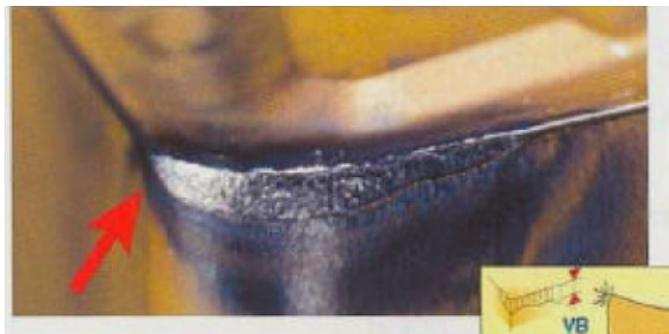
**Figura 2.9 – Desgaste de flanco na aresta de corte de uma pastilha (SANDVIK, 2005)**
