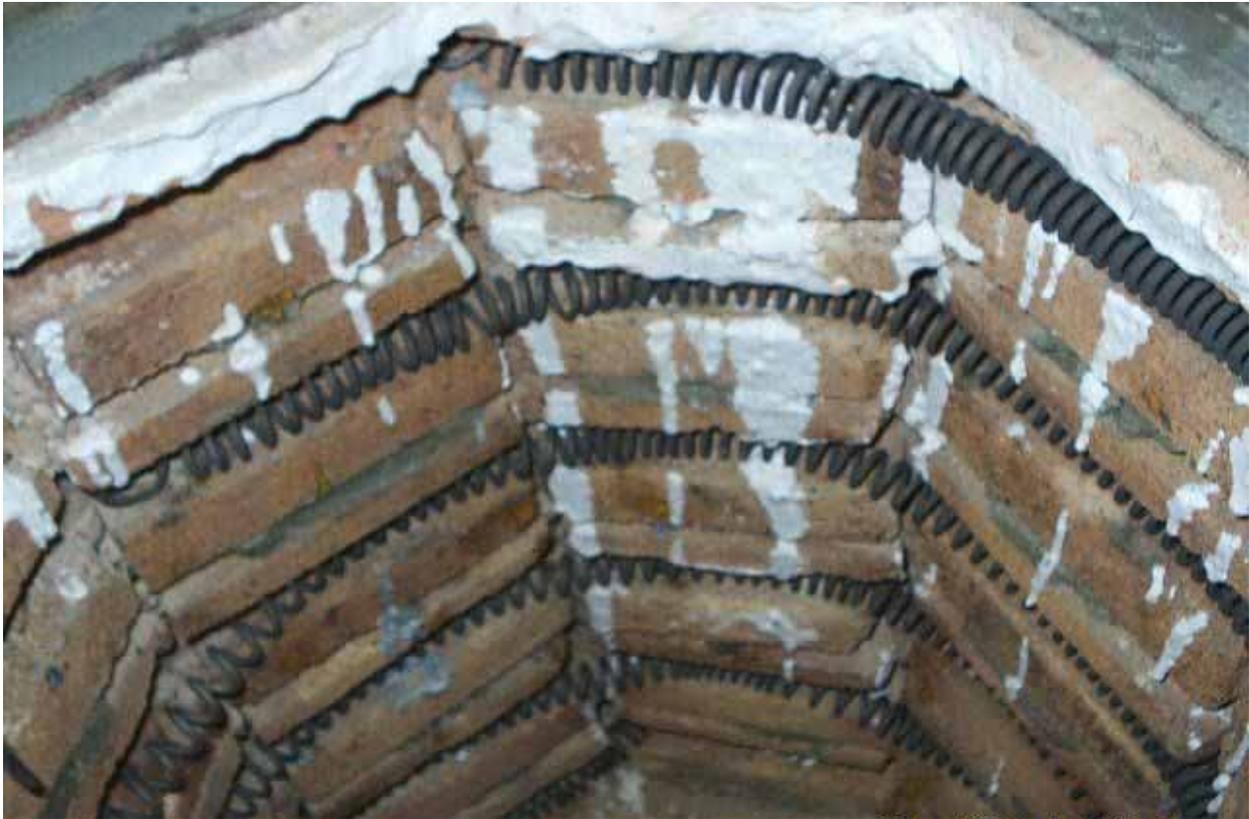
Figura 3.2 – Detalhe do forno mostrando a resistência elétrica.
