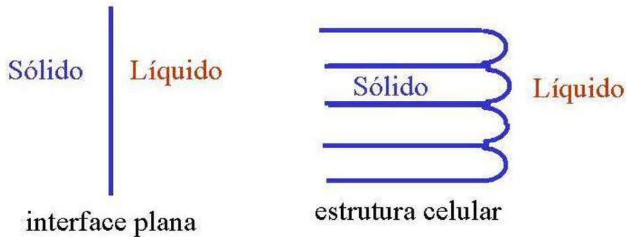
Figura 2.8 – Transição de estrutura plana para celular [Santos, 2004].
