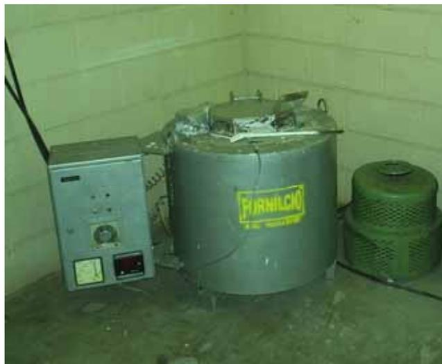
Figura 3.1 – Forno de resistência elétrica utilizado para refundir a liga AA5052.
