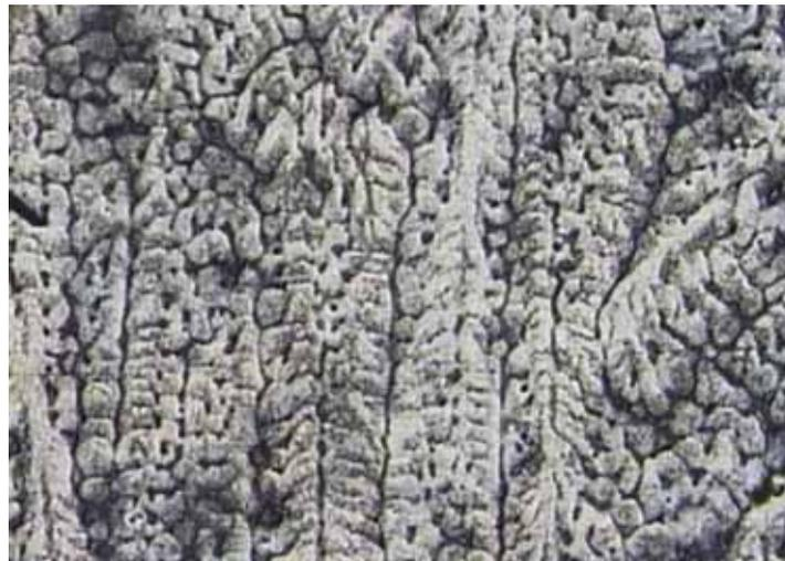
Figura 2.11 – Micrografia de uma liga com estrutura dendrítica [Santos, 2004].
