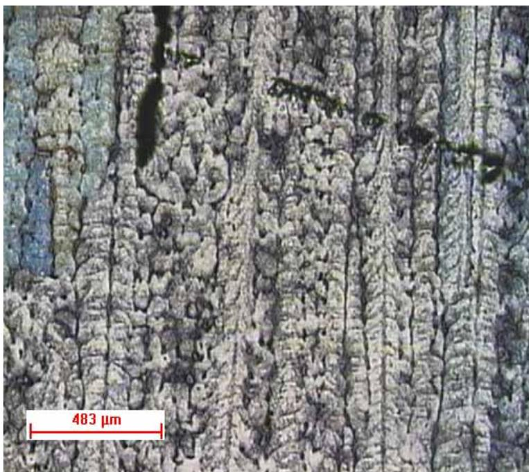
Figura 4.19 – Micrografia da seção longitudinal a 20 mm da interface metal/molde na região da zona colunar para a temperatura de superaquecimento de 780°C.
