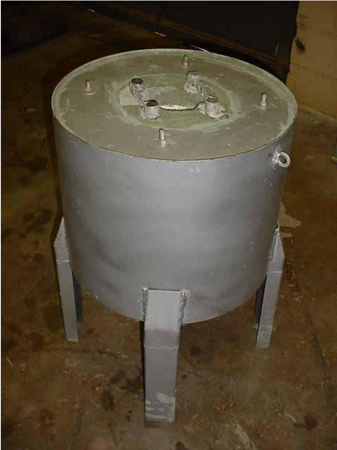
Figura 3.4 – Dispositivo de solidificação unidirecional.
