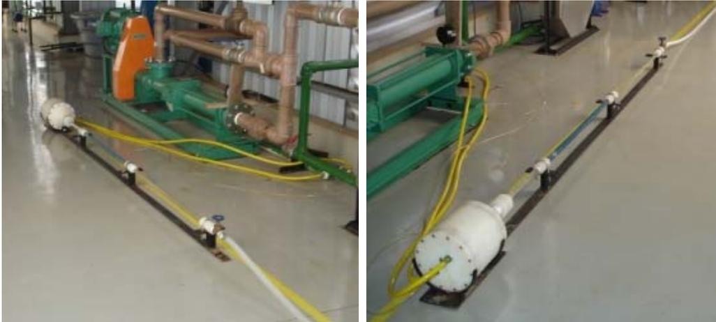
*Figura 3.5 – Sistema de injeção (misturador bifásico).*
