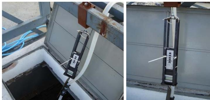
*Figura 3.9 – Dinamômetro e conexão de topo do modelo.*
