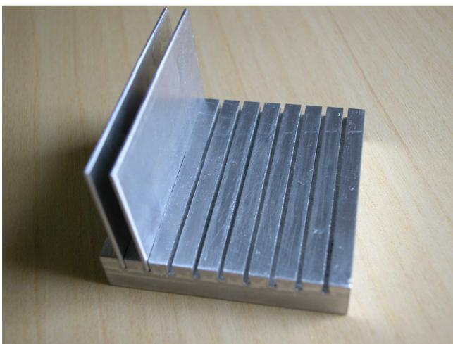
Figura 3.6 – Base do Dissipador com suas Ranhuras.
