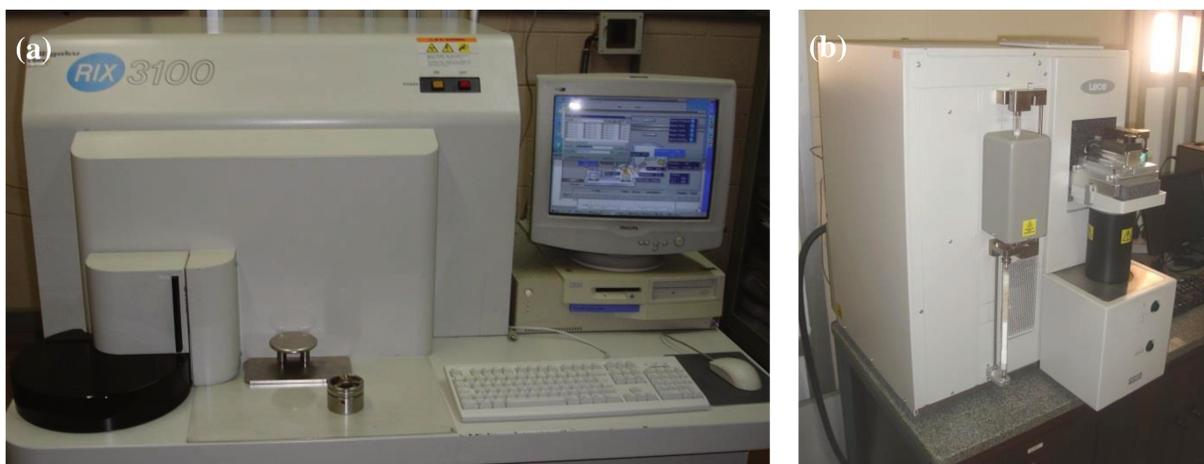
Figura 3.3 Espectrômetro de fluorescência de raios-X e (b) analisador de O e N.
