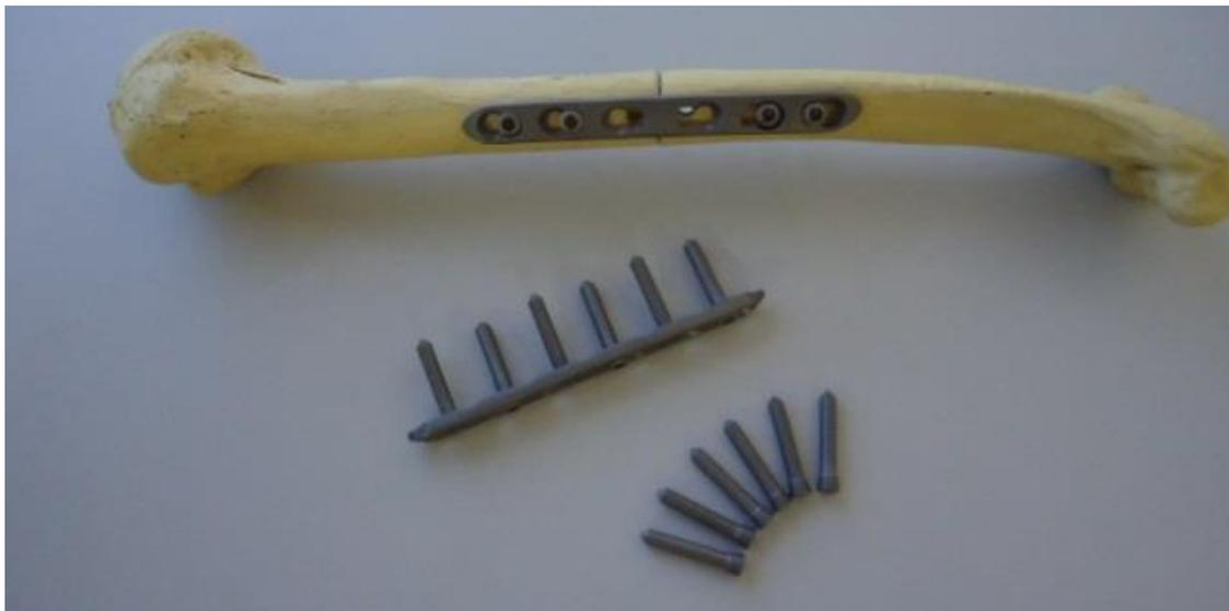
Figura 4.50 Imagens mostrando as placas e parafusos de osteossíntese usinadas a partir da liga Ti-30Nb-3Fe.
