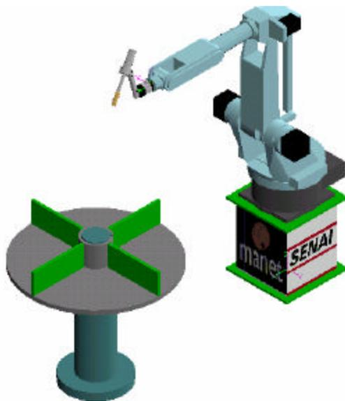
Figura 3.8 Exemplo de uma célula de trabalho com solda robotizada
