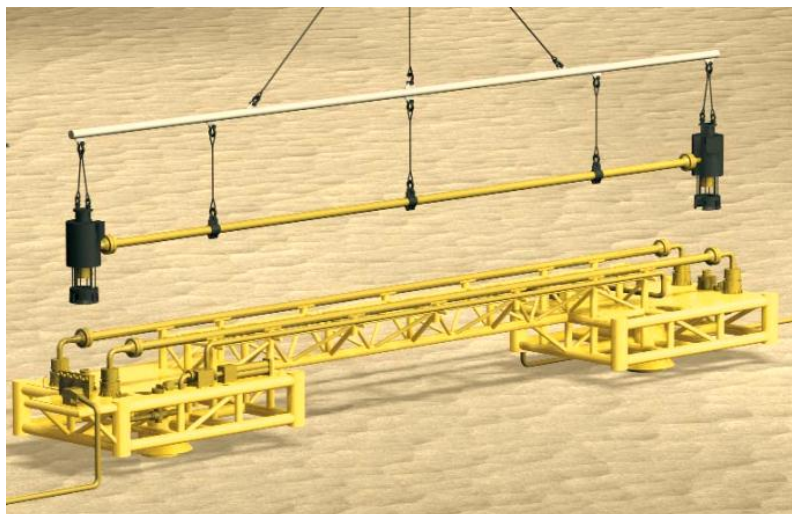
Figura 2.19 – Exemplo esquemático de um Horizontal ESP System (Lawson, 2004).
