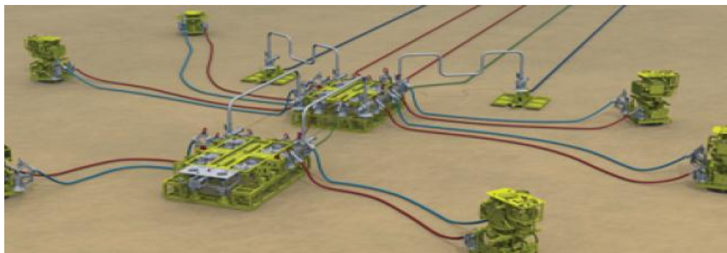
Figura 2.17 – Desenho esquemático do sistema submarino do campo de Mexilhão onde é possível observar jumper s (na cor cinza) conectando um equipamento ao outro (FMC Technologies).
