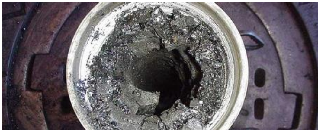
Figura 2.5 – Exemplo de deposição asfáltica em uma coluna de produção ( http://www.bakerhughes.com/ - acessado 04/03/2012).
