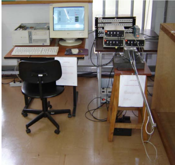
Figura 7.8: Bancada experimental para controle de viga engastada em uma das extremidades.
