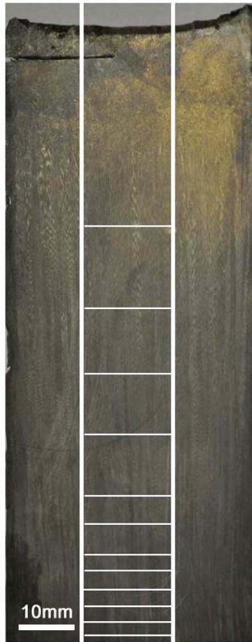
**Figura 3.5.** Esquema da obtenção de amostras para análise de: macrossegregação e microestruturas.
