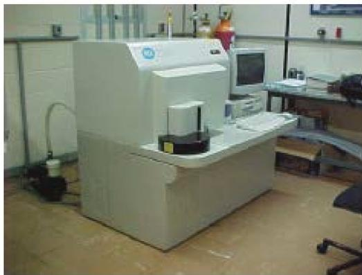
**Figura 3.6.-** Espectrômetro de fluorescência de raios X, modelo Rigaku RIX 3100.
