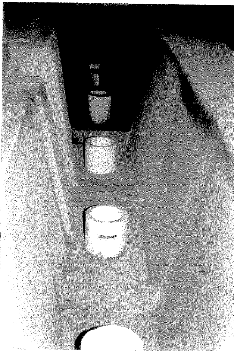
Figura 6.8 - Montagem de barragens no distribuidor industrial, configuração E.
