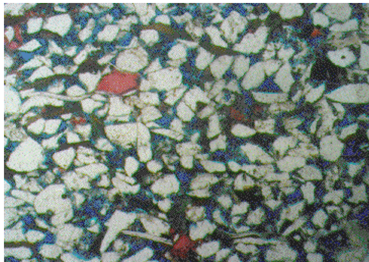
Figura 6.33: Foto de lâmina correspondente à amostra 9501H, mostrando a presença de argila intersticial (esverdeada) e calcita microcristalina (vermelho).
